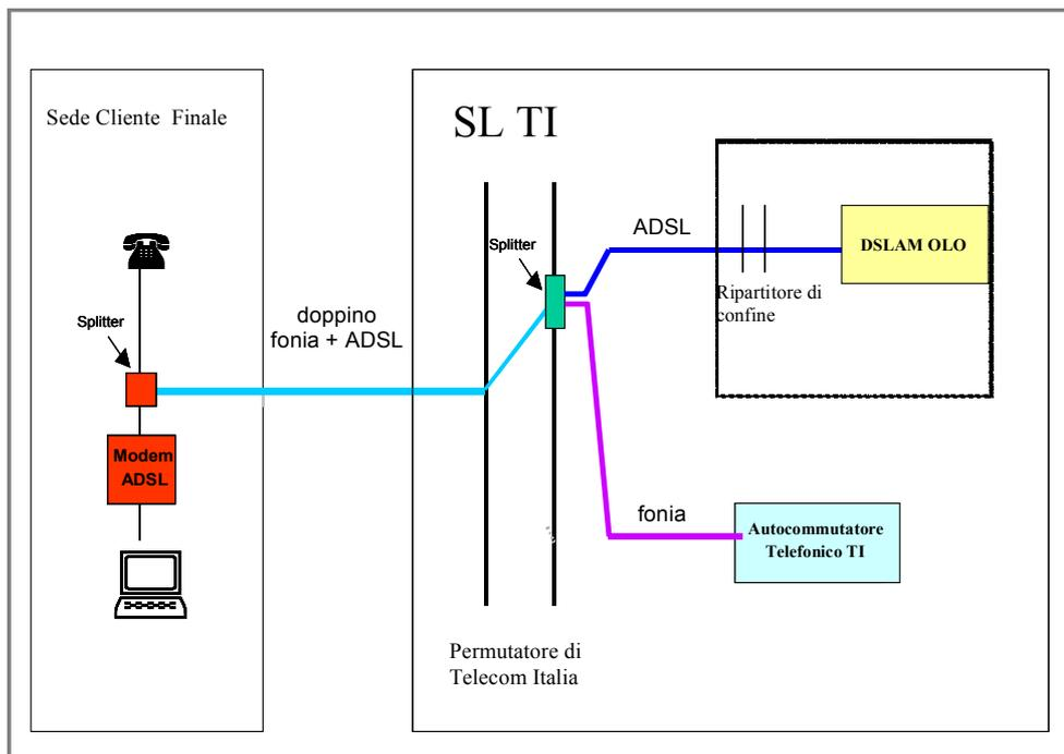
Figura 5: Servizio di accesso condiviso con splitter in centrale fornito da TI
