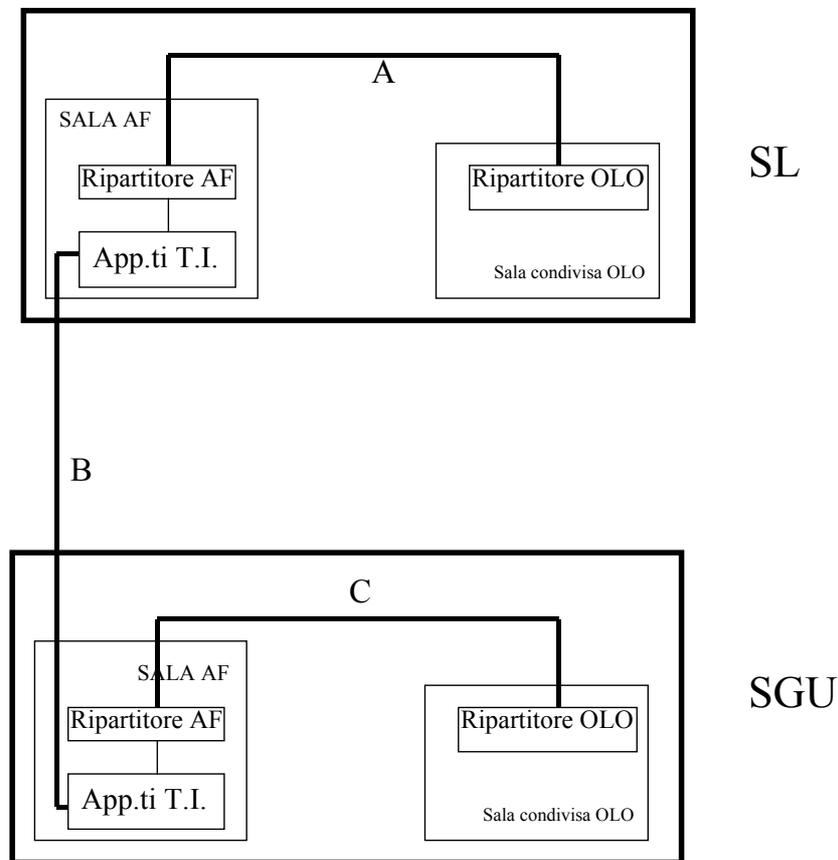
**Figura 16** - Prolungamento dell'accesso SL-SGU con canale numerico
