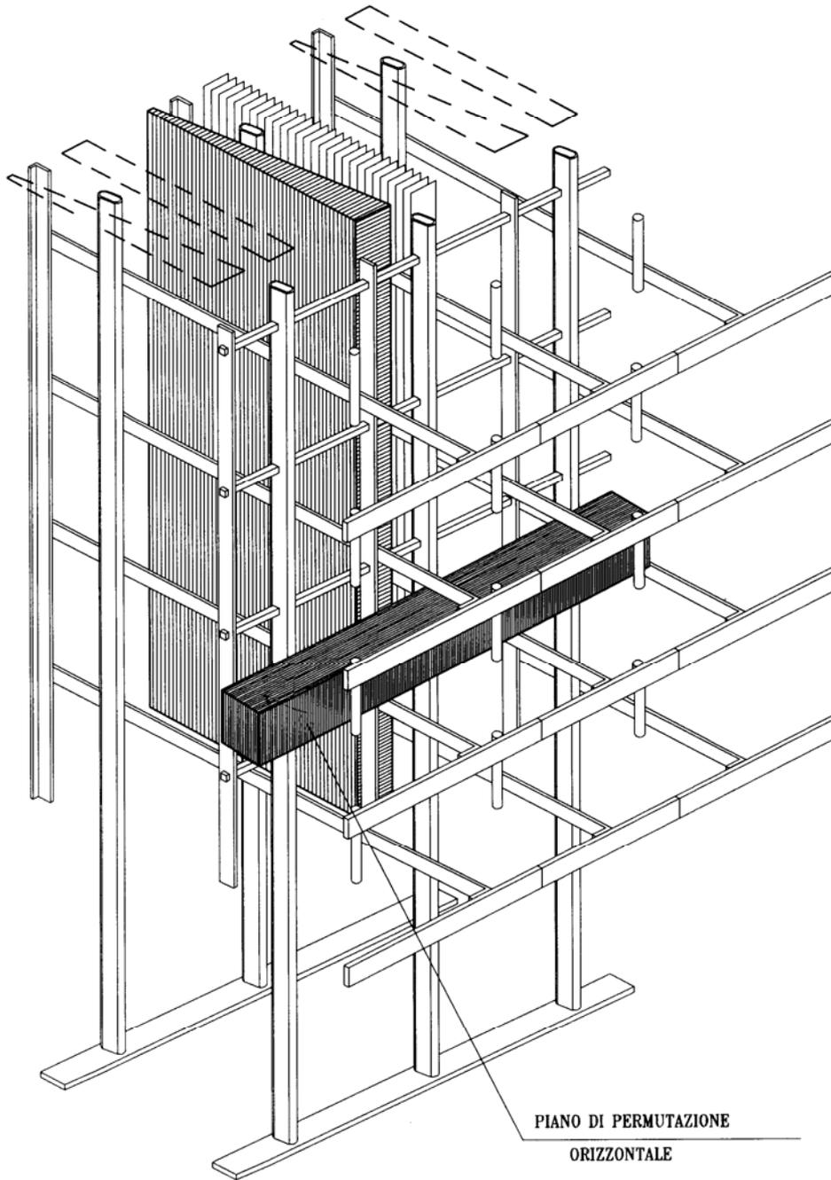
**Figura 25 Piano di permutazione orizzontale di un ripartitore bifronte**
