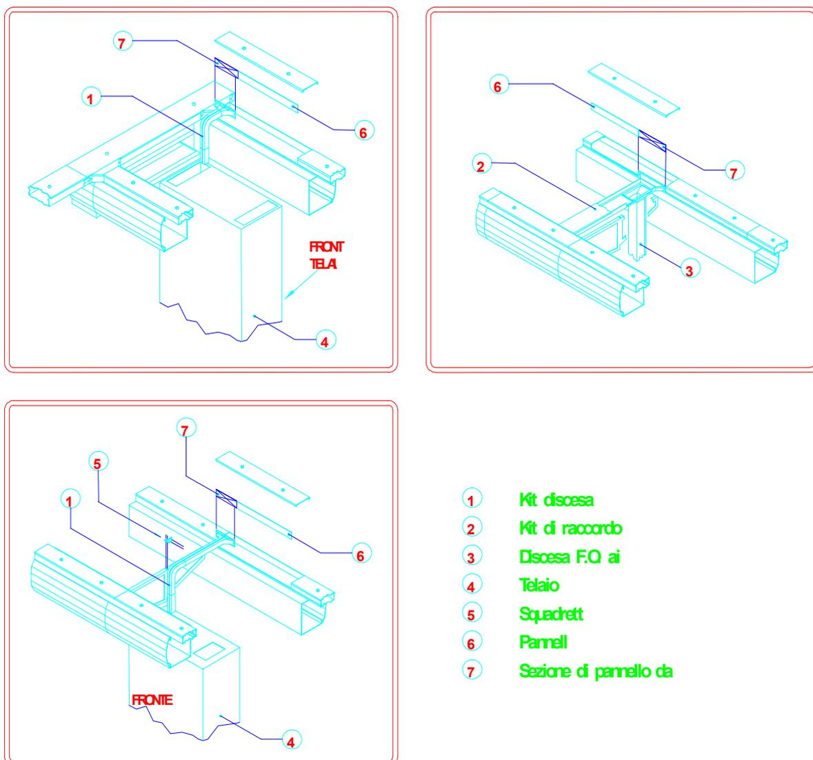
Figura 30: Esempio di canalizzazioni per discese f.o.
