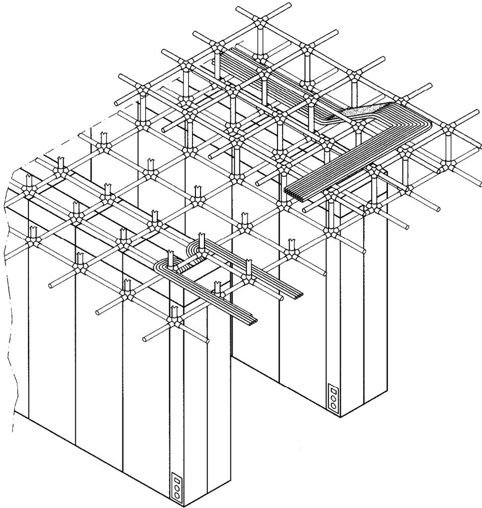
**Figura 22: esempio di discesa cavi verso un telaio N3**
