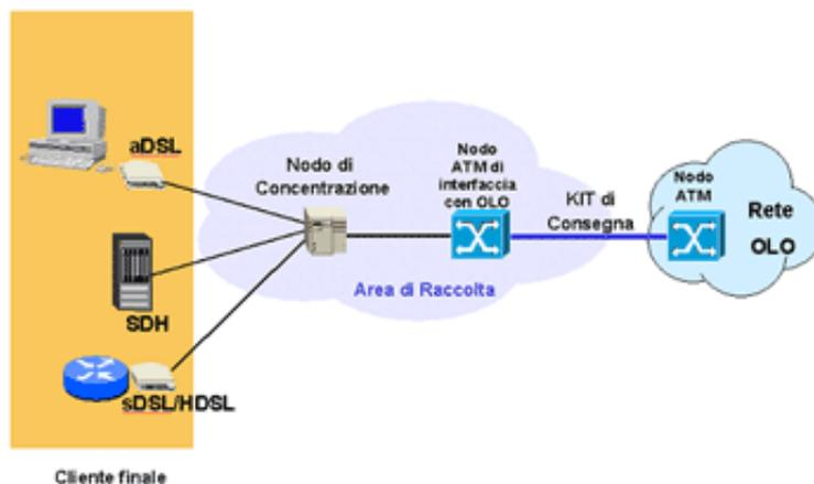
Il CVP si configura come un servizio di raccolta dati a pacchetto ad alta velocità (ATM), basato sull'integrazione delle tecnologie trasmissive xDSL ed SDH lato cliente finale con consegna a livello ATM lato Operatore.
