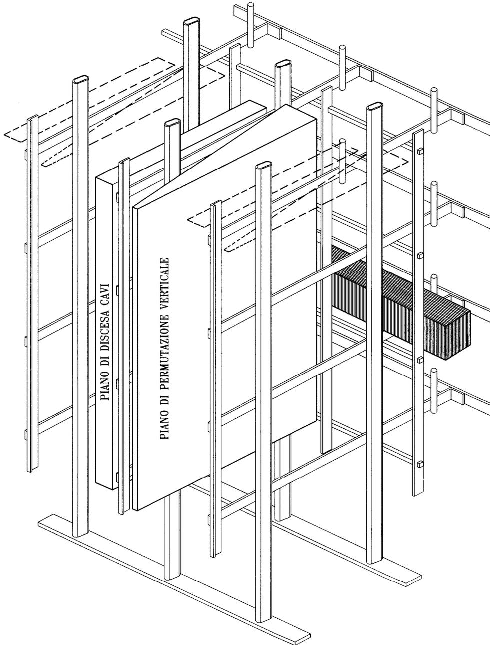
**Figura 26 Piano di discesa cavi e piano di permutazione verticale di un ripartitore bifronte**
