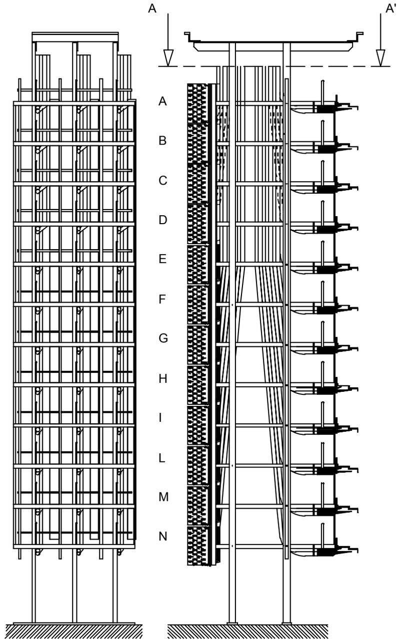
**Figura 28: Esempio di discesa cavi su ripartitore RP3/C**
