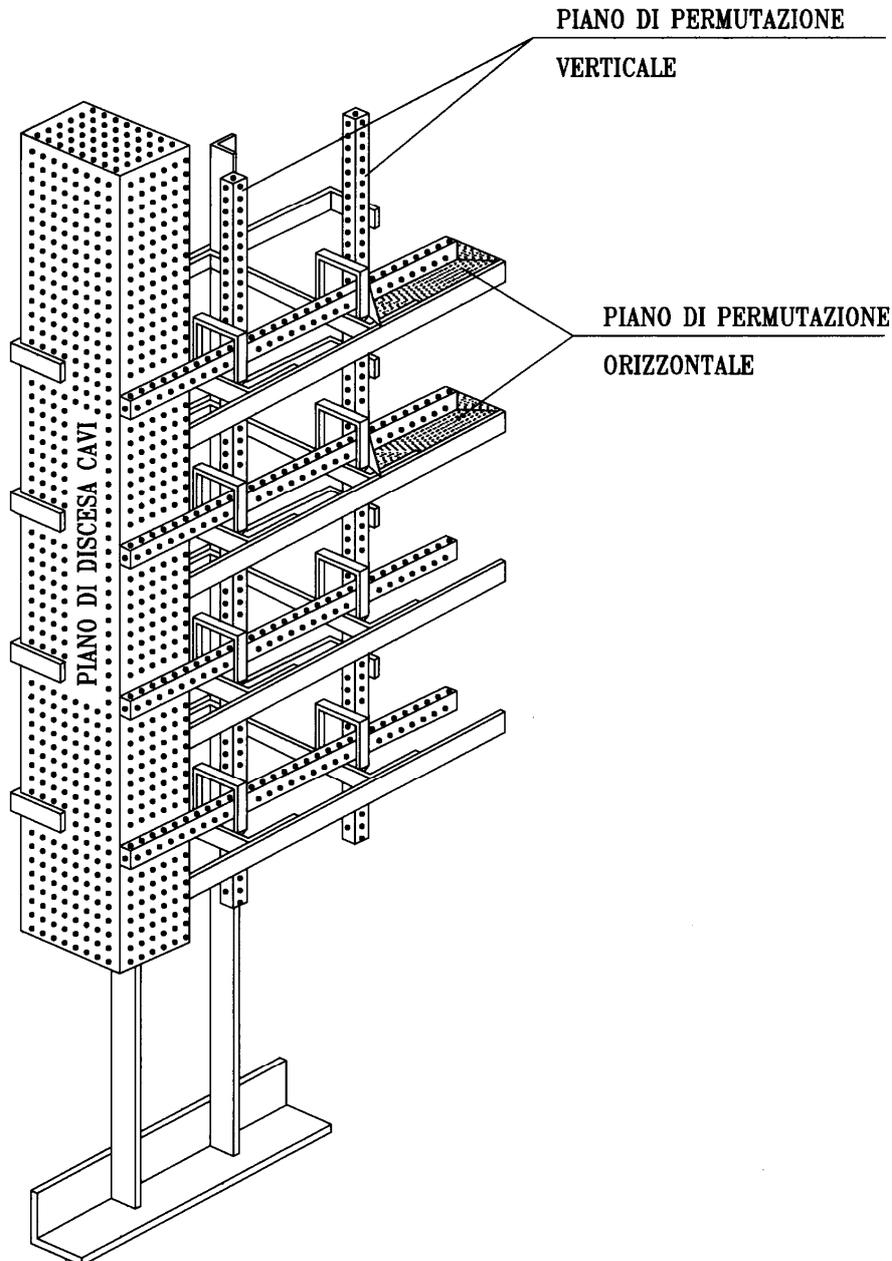
Figura 27 Piani di permutazione (orizz. e vert.) e piano di discesa cavi di un ripartitore monofronte
