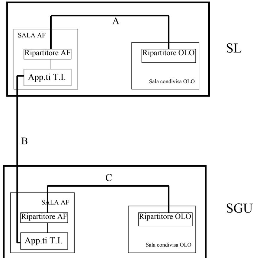
**Figura 16** - Prolungamento dell'accesso SL-SGU con canale numerico
