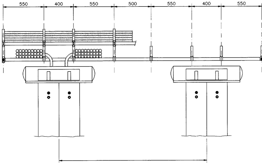
**Figura 24: vista frontale (dal Quadro di Fila) del percorso cavi sul planare**
