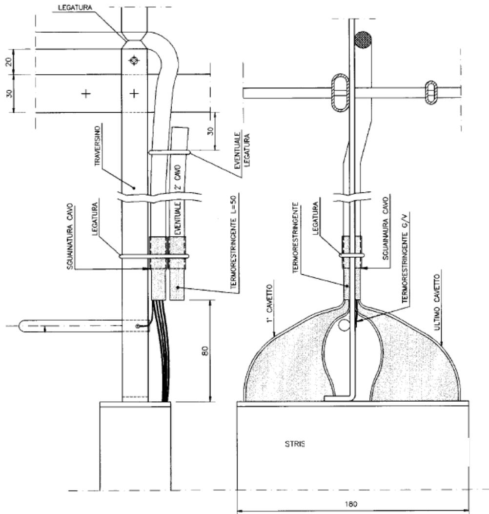
**Figura 67 Sagomatura dei cavi AF con schermo elettromagnetico nei Ripartitori (Lato Orizzontale)**
