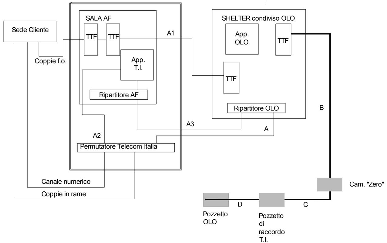
**Figura 2 Colocazione Fisico B (esterno con shelter)**
