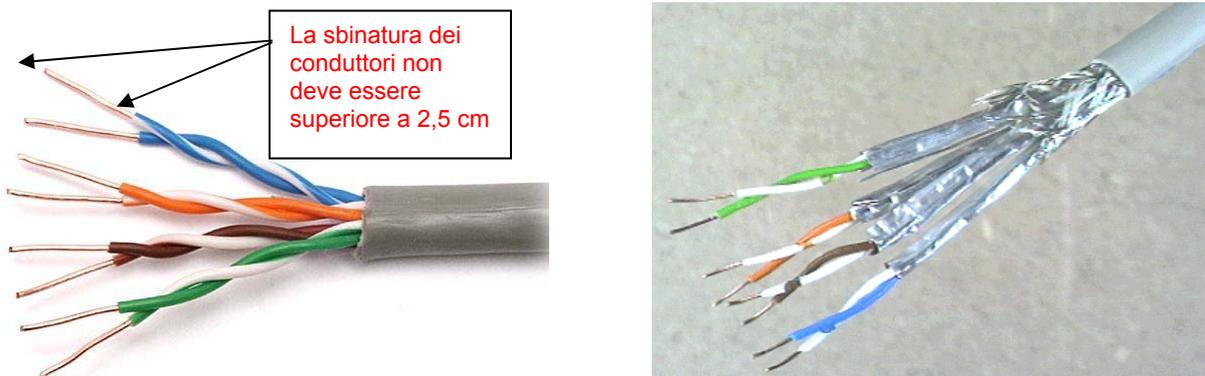
**Figura 56 – Esempio di sguainatura del cavo UTP/STP**
