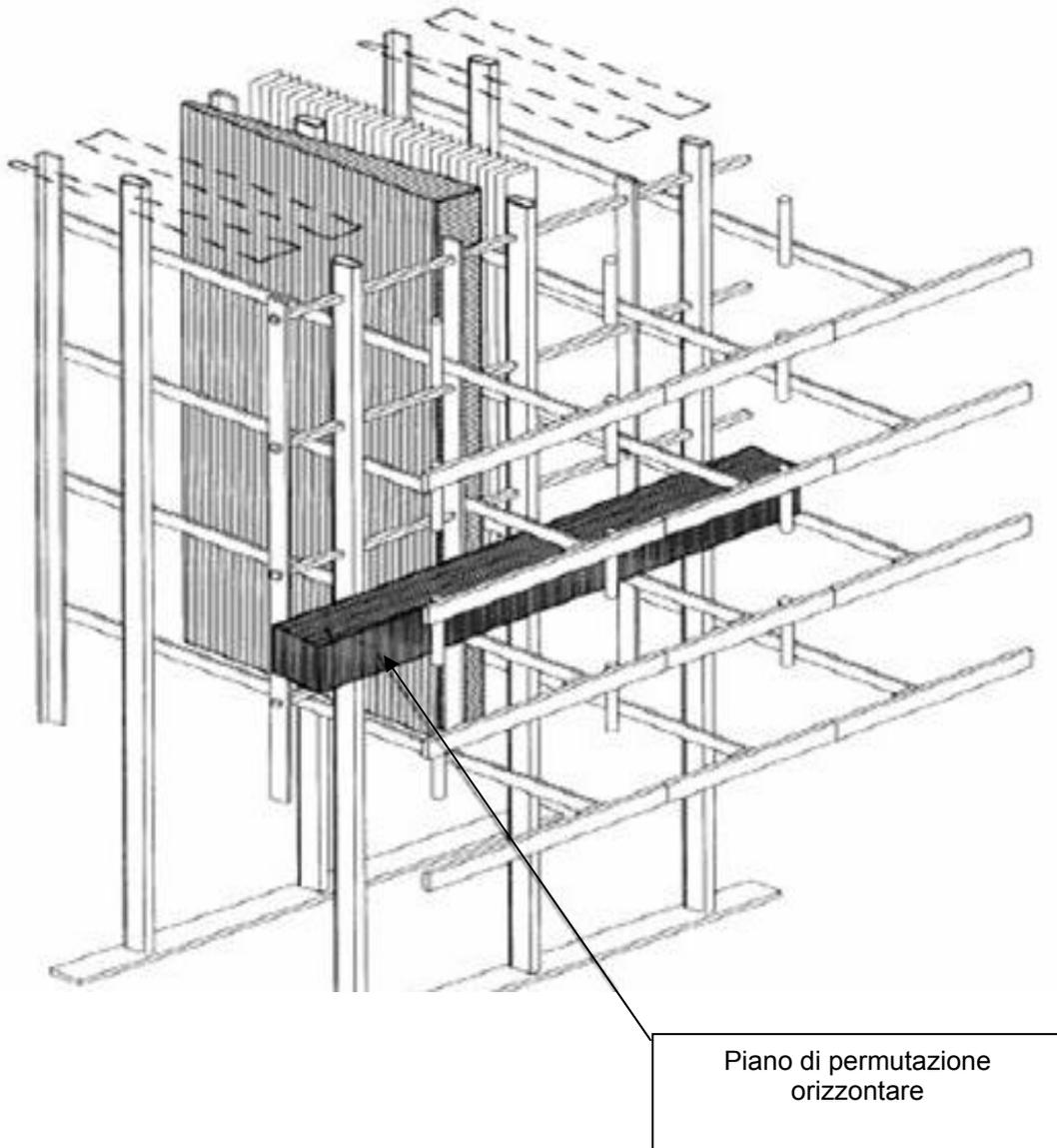
**Figura 21 Piano di permutazione orizzontale**
