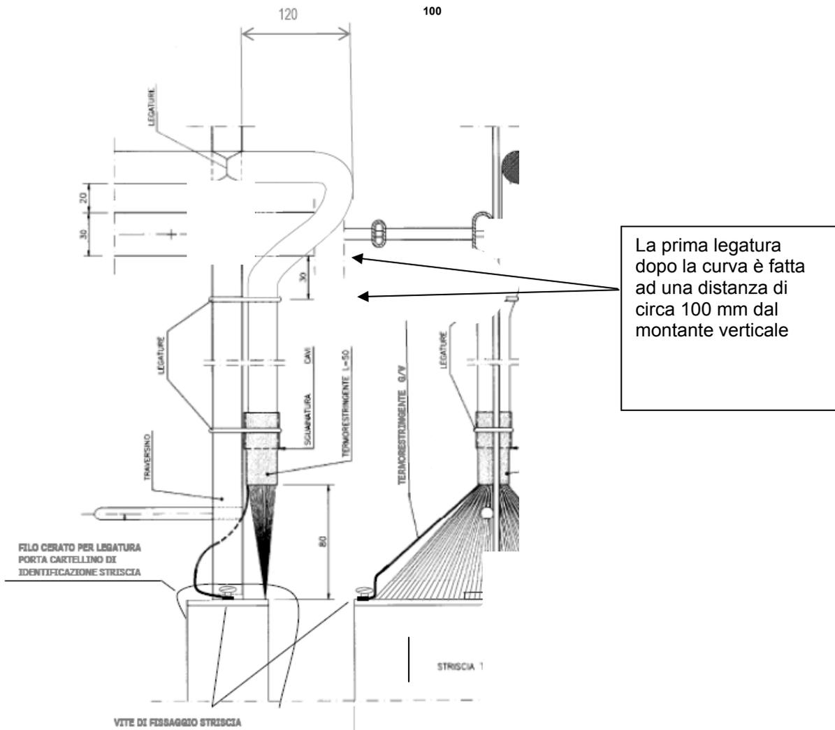
**Figura 43 - Sagomatura dei cavi BF (per raccordi ULL) con schermo elettromagnetico o elettrostatico sui permutatori (LATO ORIZZONTALE)**
