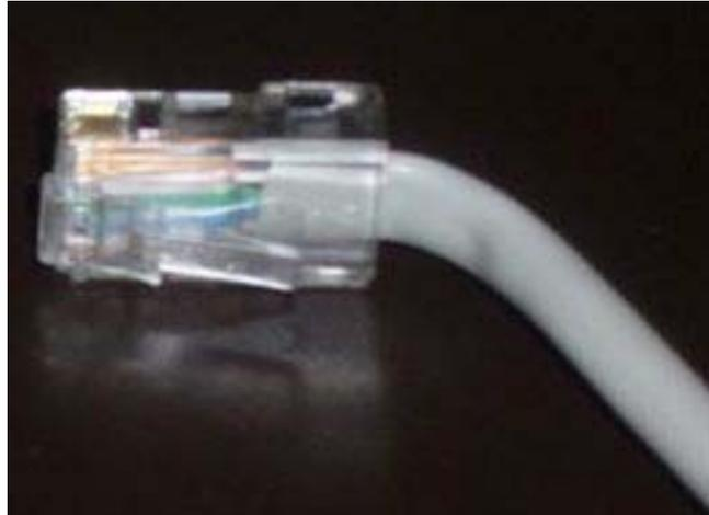
*Figura 60 – Connettore maschio RJ45*
