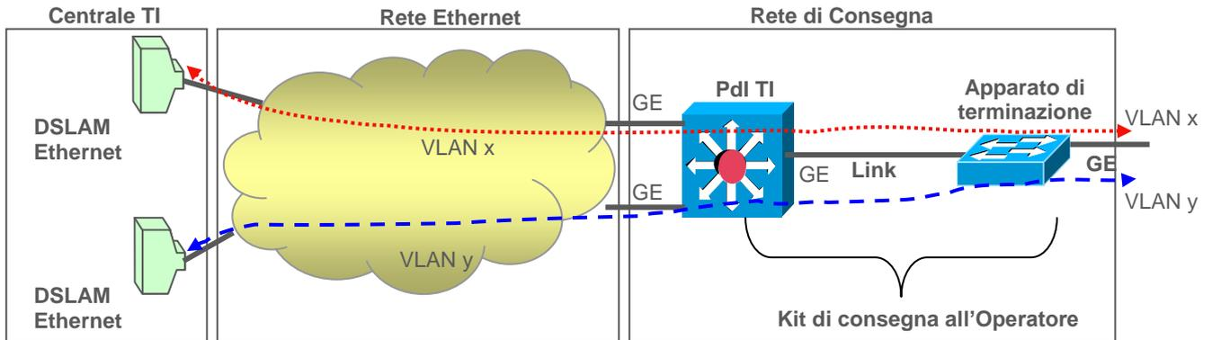
**Figura 4: Architettura del trasporto Ethernet**
