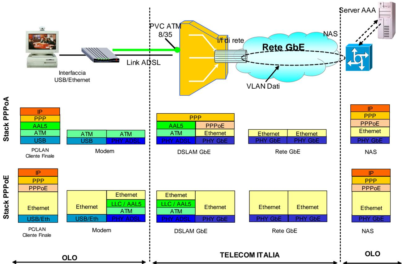
La sorgente di traffico del cliente finale dell'Operatore trasmette i propri dati con protocollo PPP su Ethernet (PPPoE) o su ATM (PPPoA) utilizzando un modem Ethernet, un modem Combo (sia Ethernet che USB) oppure un modem solo USB.
