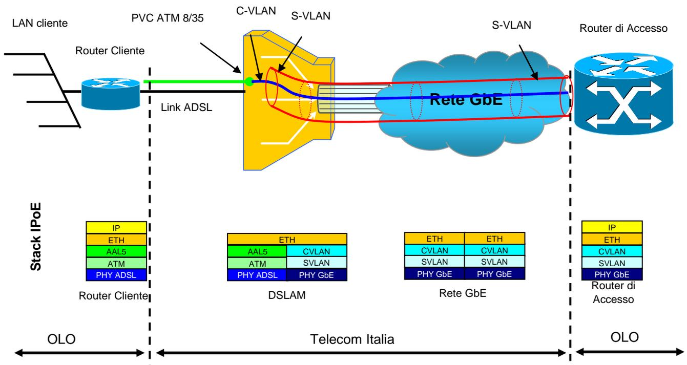
La sorgente di traffico del cliente finale dell'Operatore trasmette i propri dati con protocollo IP su Ethernet (IPoE) utilizzando una CPE Ethernet (Router Cliente).
