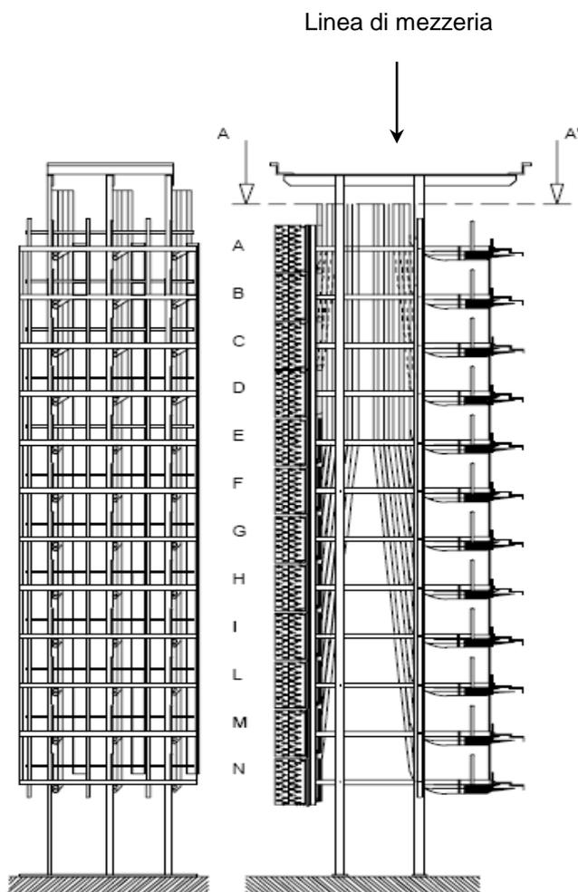
**Figura 36 – Discesa cavi su Ripartitore elettrico RP3C/12L vista frontale e laterale**
