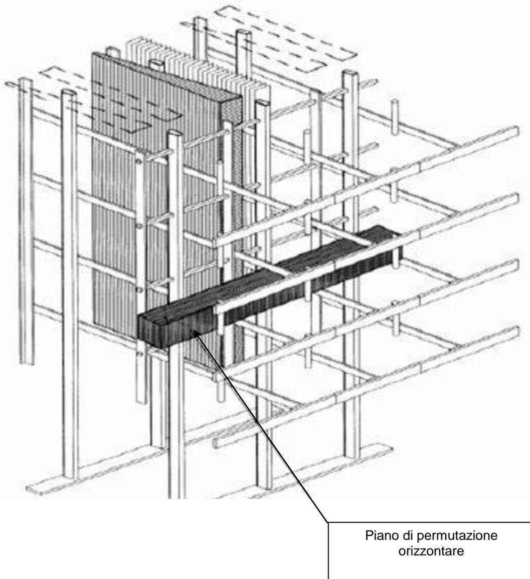
**Figura 21 – Piano di permutazione orizzontale**
