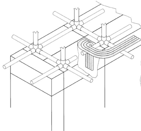
**Figura 27 – Esempio di posa cavi sulla struttura di fila e discesa verso l'apparato**
