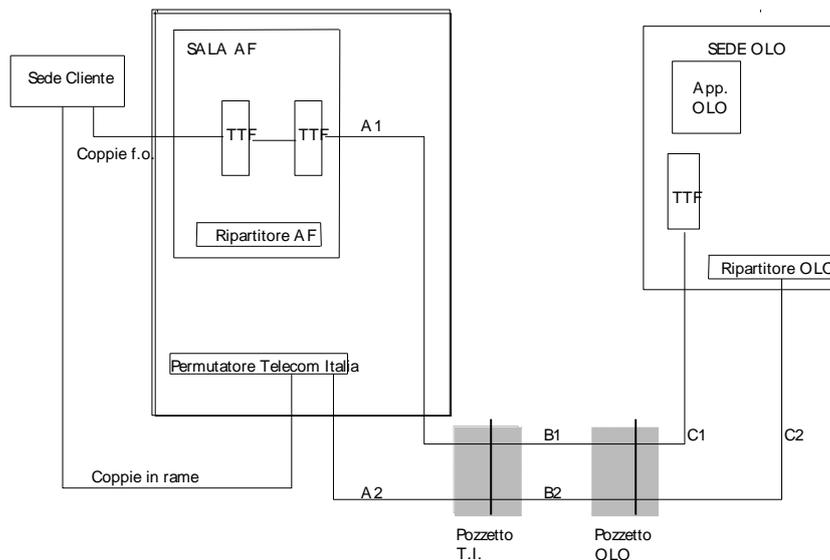
Legenda: Cavo A1 = Cavo B1 = Cavo C1 = Cavo ottico, Cavo A2 = Cavo B2 = Cavo C2 = Cavo a coppie in rame
