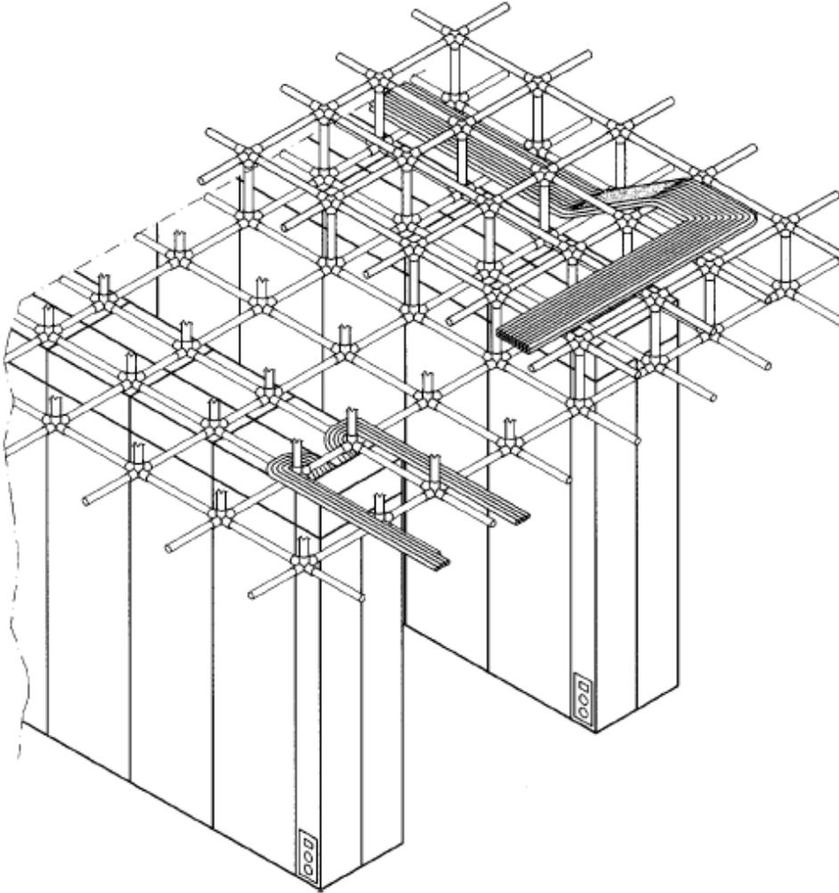
**Figura 29 – Esempio di posa su 2° livello Planare**
