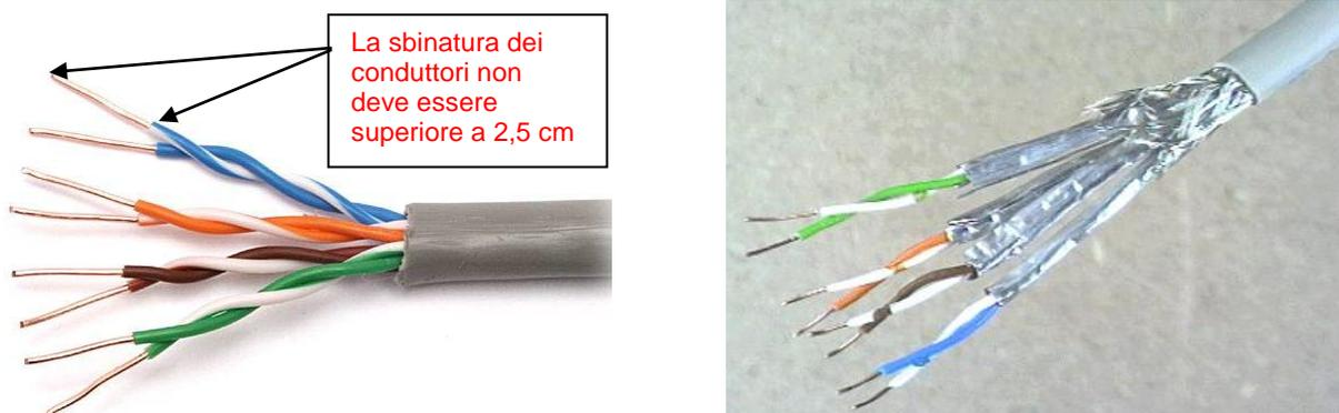
**Figura 56 – Esempio di sguainatura del cavo UTP/STP**
