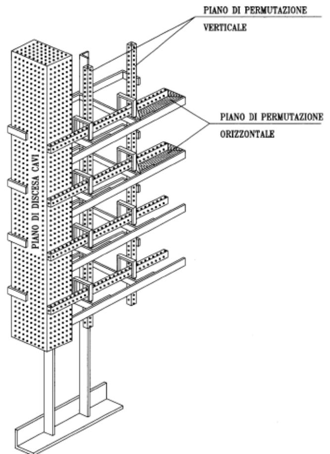
**Figura 23 – Piano di Permutazione Orizzontale, Permutazione Verticale e Piano di discesa cavi**
