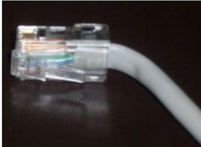
**Figura 60 – Connettore maschio RJ45**
