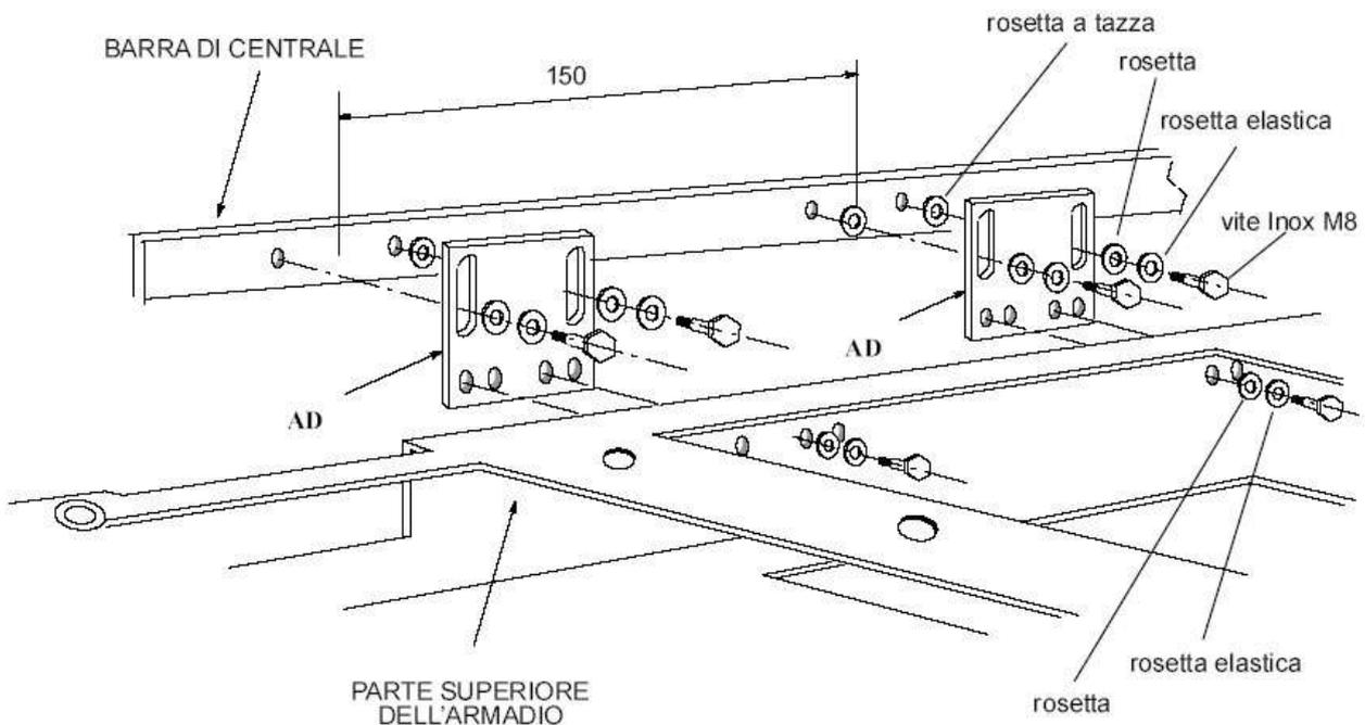
**Figura 73 – Fissaggio del telaio alla struttura di fila**
