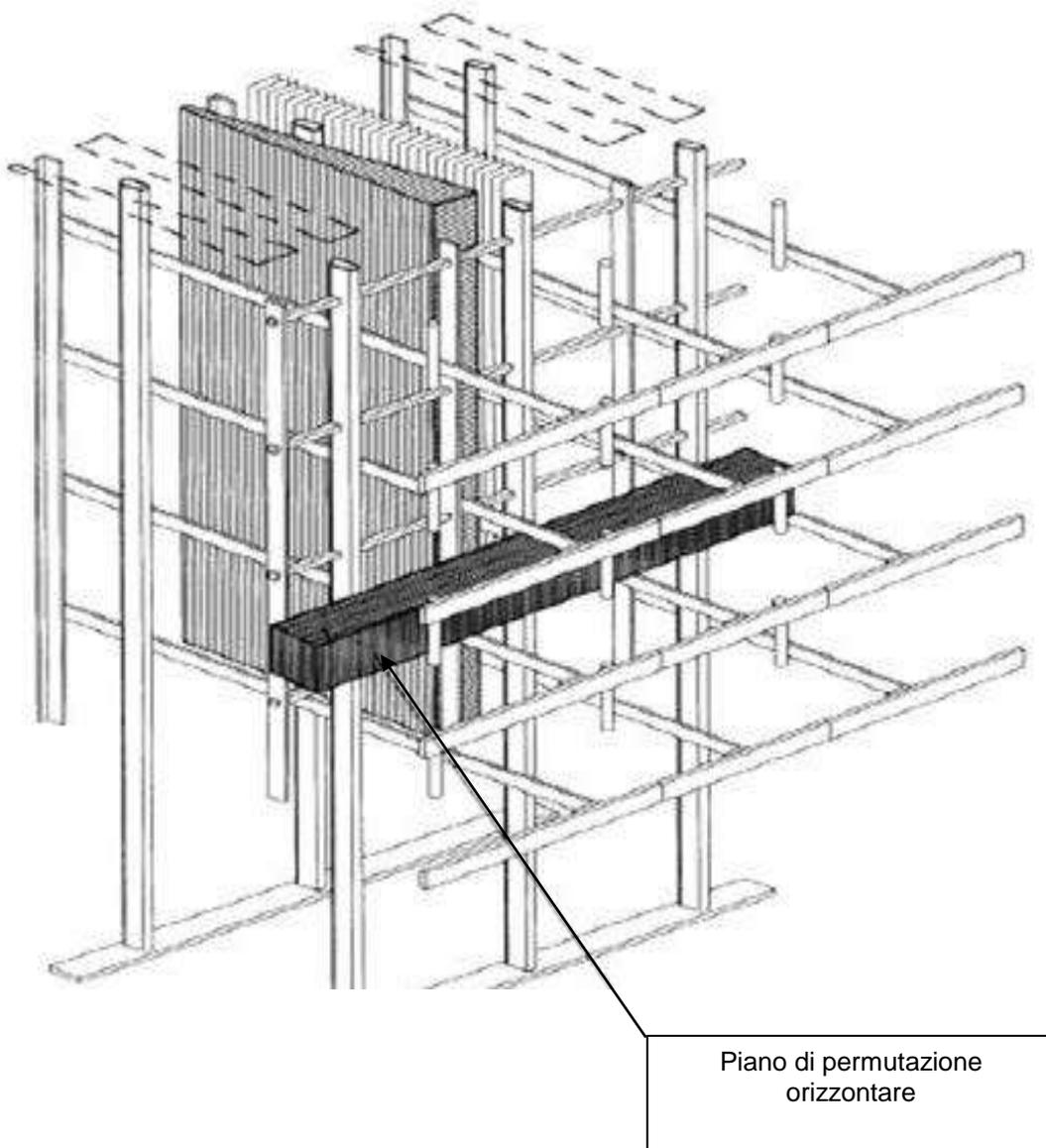
**Figura 21 – Piano di permutazione orizzontale**
