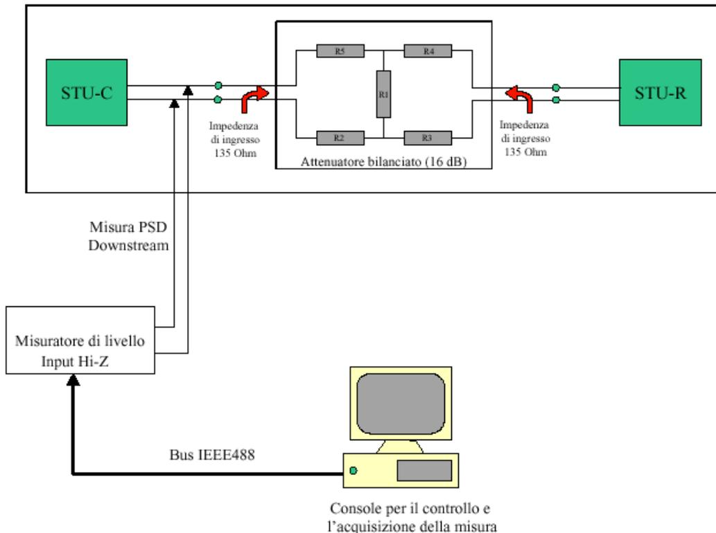
Sono eseguite le misure della densità spettrale di potenza trasmesse sia dall'STU-C sia dall'STU-R per i quattro profili di livello fisico con i seguenti bit rate: 384, 768, 1024, 2048 kbit/s e viene verificata sia la conformità alle maschere standard sia la conformità ai limiti di potenza totale trasmessa imposti dallo standard G.991.2.
