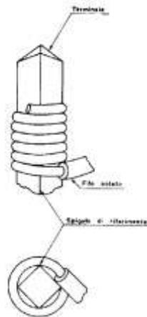
**Figura 46 – Esempio di connessione avvolta**
