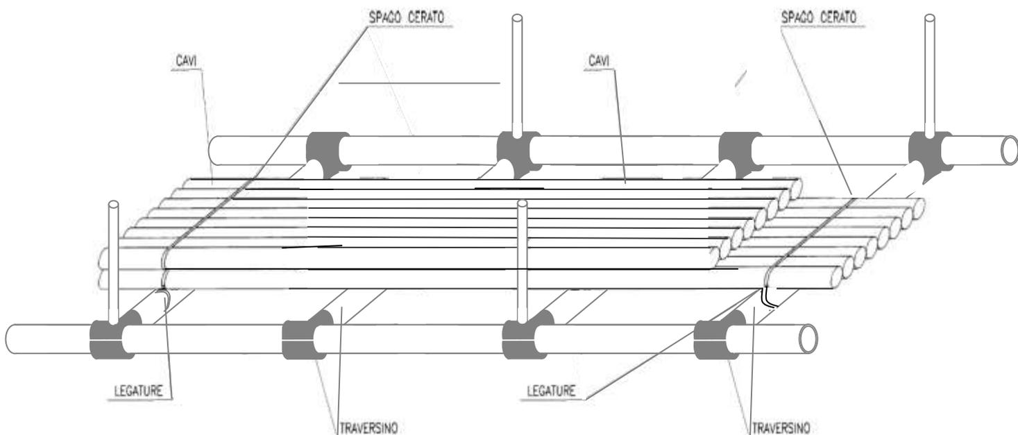
**Figura 30 – Esempio di legatura a “Fascio”**
