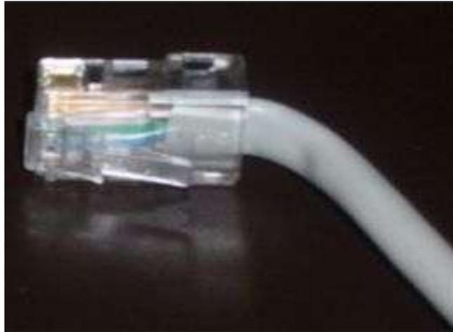
**Figura 60 – Connettore maschio RJ45**
