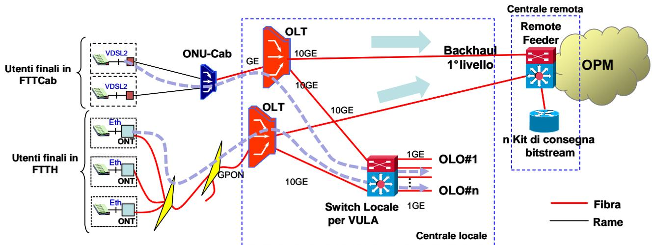
**Figura 2: Architettura della rete di accesso per i servizi bitstream su rete NGA.**
