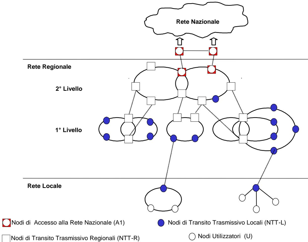
**Figura 1: Architettura della rete trasmissiva di Telecom Italia**
