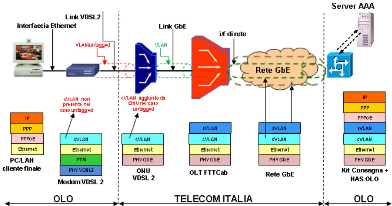
Figura 10: Protocollo PPPoE su accessi FTTCab su banda “Double tag”
