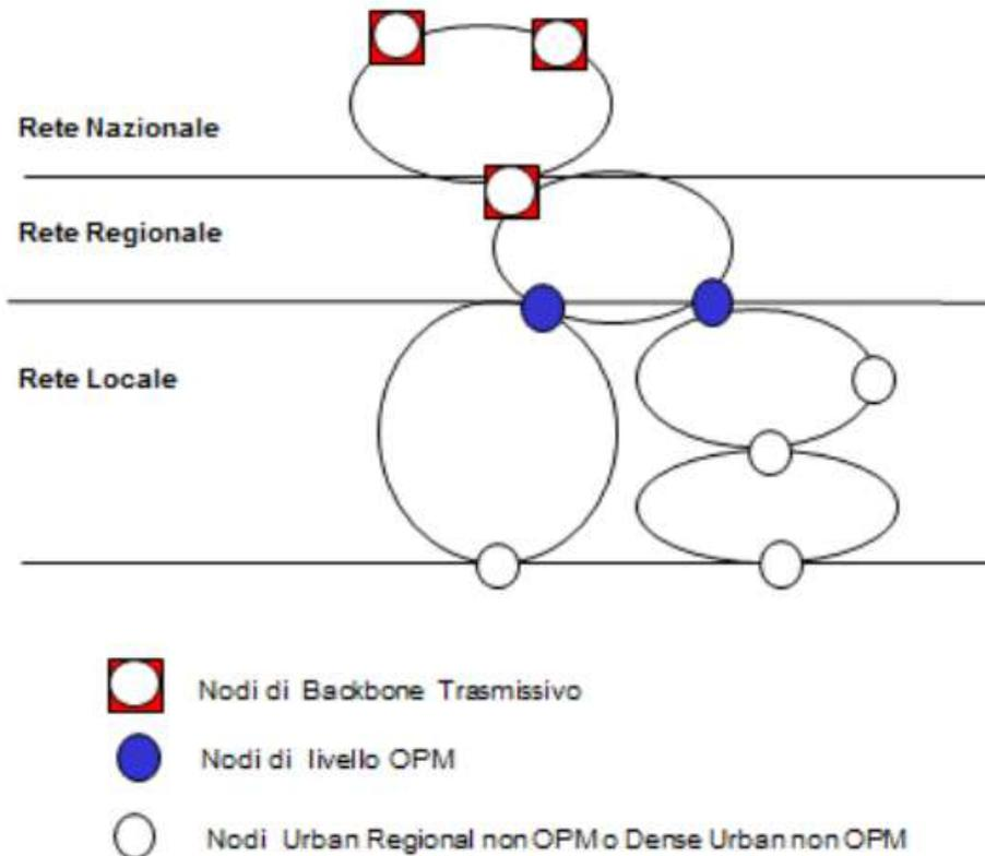
**Figura 1: Architettura della rete trasmissiva di Telecom Italia**
