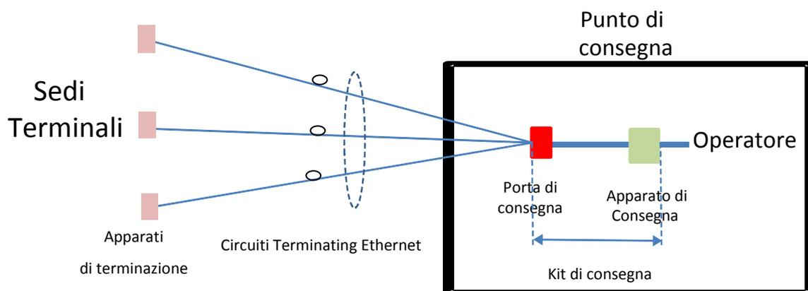
Per ogni Circuito *Terminating Ethernet su fibra ottica* è configurata una sVLAN (Service VLAN), la cui velocità di picco può arrivare fino a 1 Gbit/s secondo la seguente granularità:
