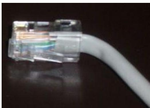
**Figura 60: Connettore maschio RJ45**
