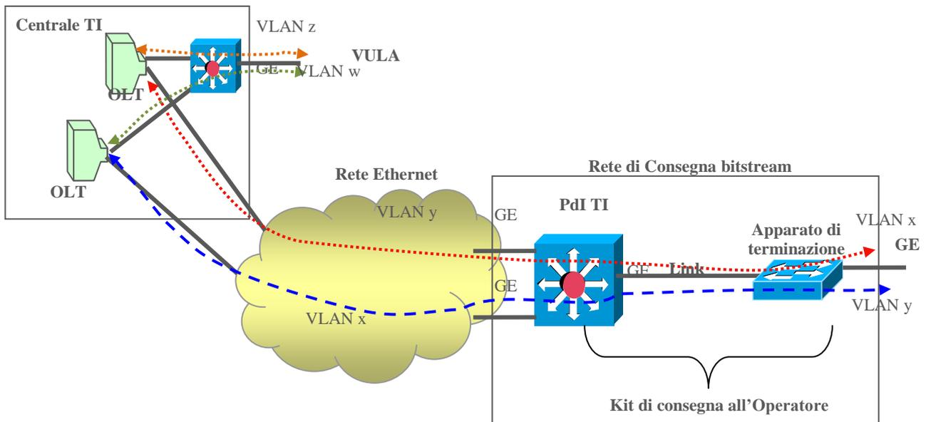
**Figura 4: Architettura del trasporto e consegna della Banda Ethernet**
