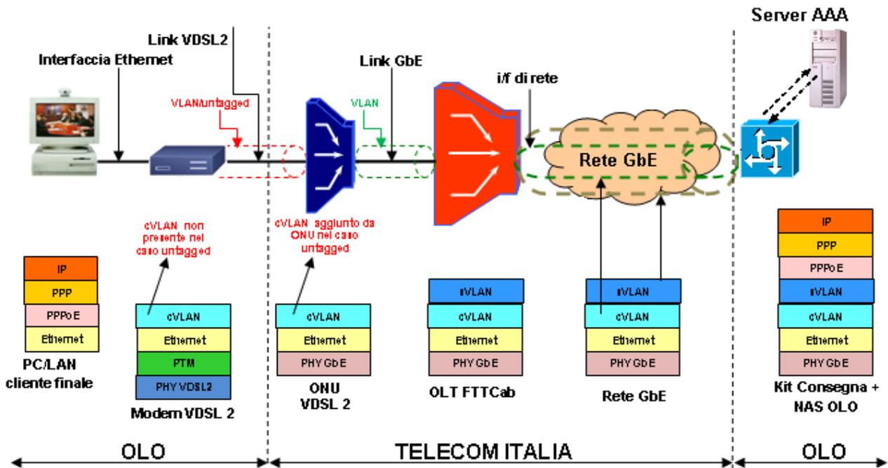
**Figura 11: Protocollo PPPoE su accessi FTTCab su banda "Double tag"**
