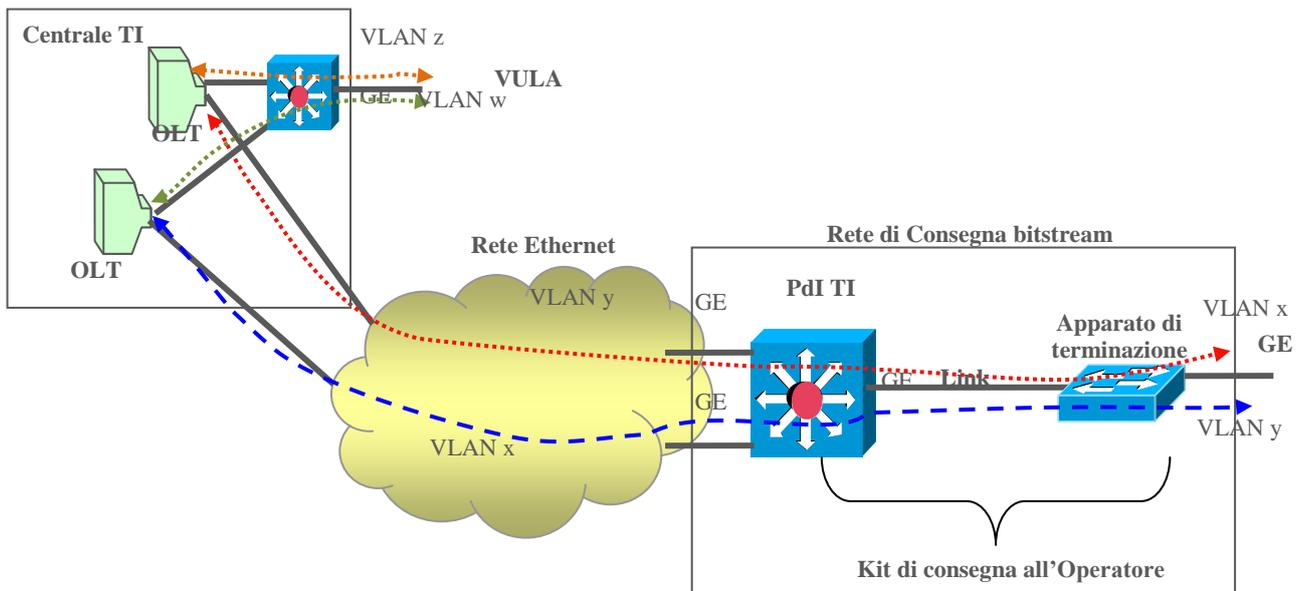
**Figura 6: Architettura del trasporto e consegna della Banda Ethernet**
