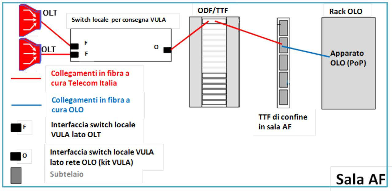
**Figura 5: Kit VULA, PoP dell’operatore presso il nodo Telecom Italia in spazi di Telecom Italia (colocazione virtuale)**
