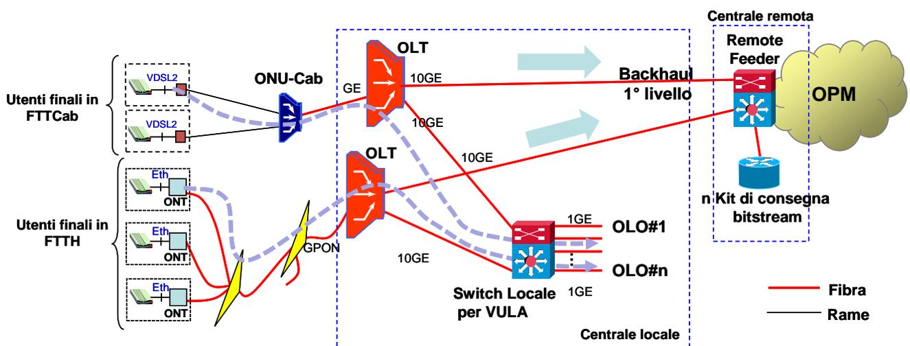
**Figura 2: Architettura della rete di accesso per i servizi bitstream su rete NGA e per il servizio VULA**
