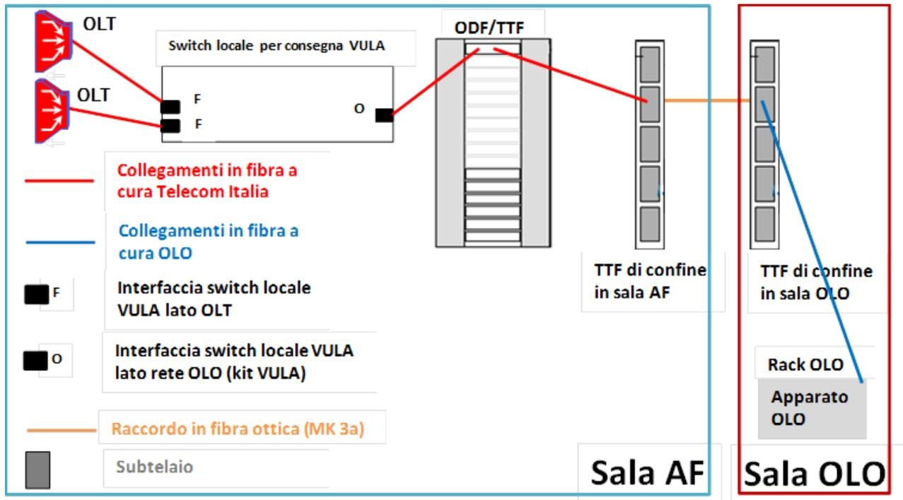
**Figura 4: Kit VULA, PoP dell'operatore presso il nodo Telecom Italia in spazi dedicati all'operatore (colocazione fisica)**
