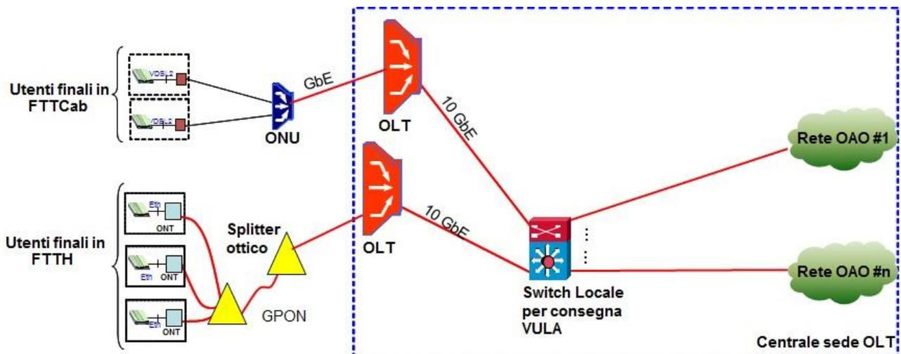
Figura 3: Architettura della rete di accesso per il servizio VULA
