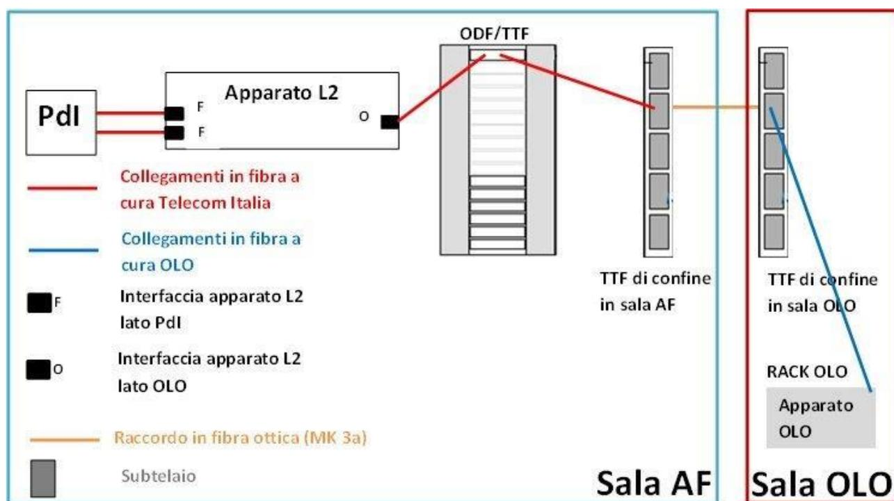
**Figura 12 – Catena impiantistica – Apparato L2 ospitato in spazi Telecom Italia, Operatore in colocazione fisica**
