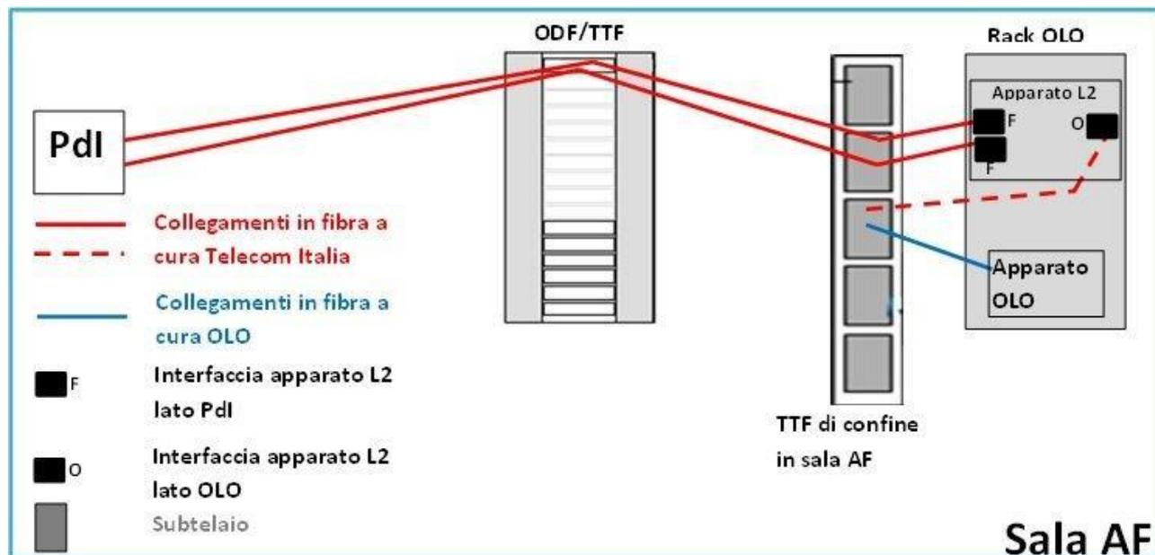
**Figura 11 – Catena impiantistica Operatore in collocazione virtuale**
