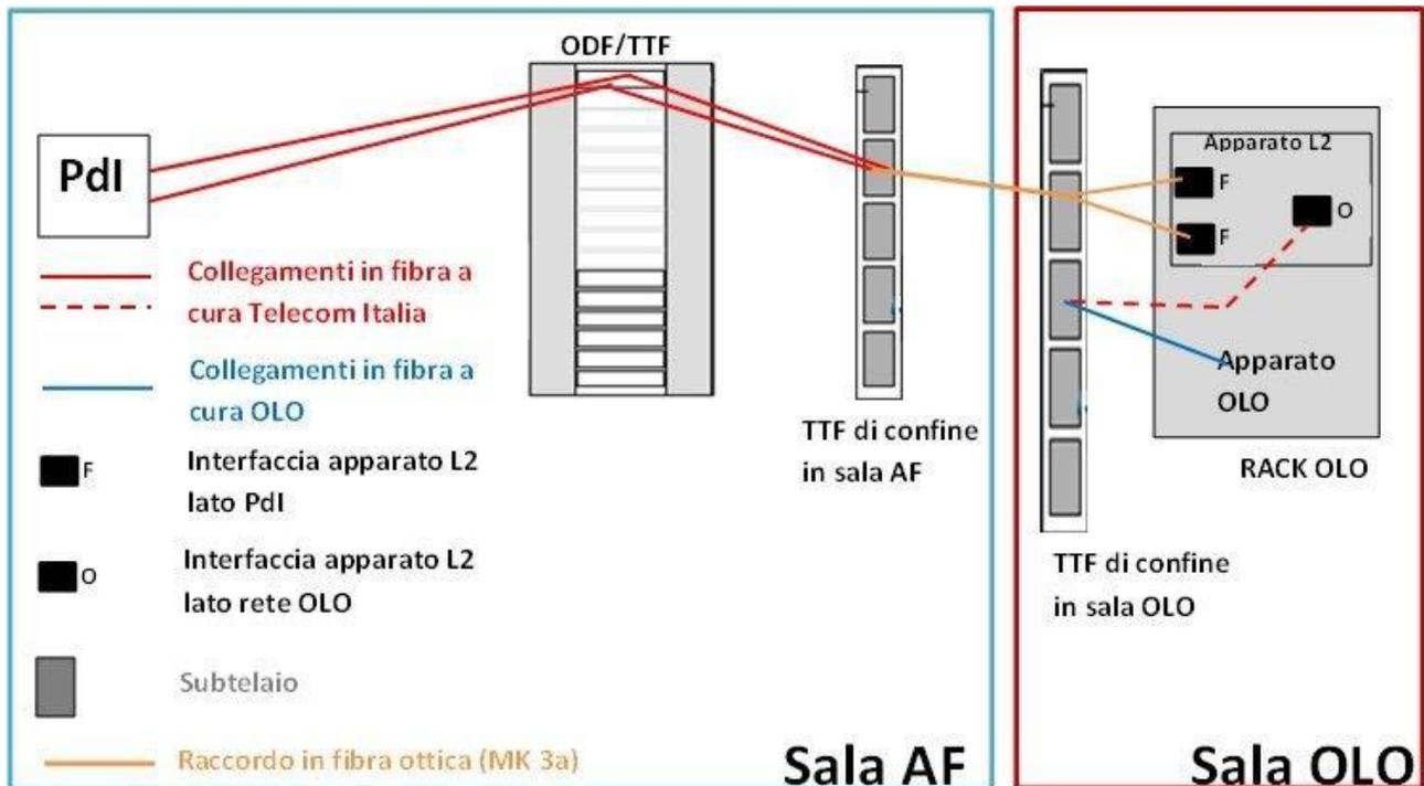
**Figura 10 – Catena impiantistica Operatore in collocazione fisica**
