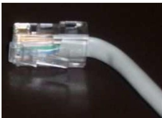
**Figura 60: Connettore maschio RJ45**
