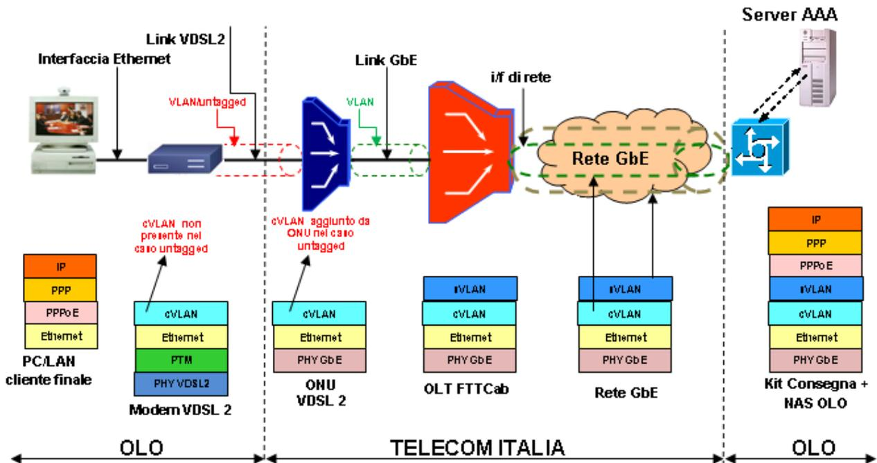
Figura 12: Protocollo PPPoE su accessi FTTCab su banda “Double tag”
