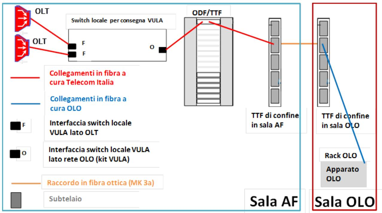
**Figura 5: Kit VULA, PoP dell’operatore presso il nodo Telecom Italia in spazi dedicati all’operatore (colocazione fisica)**
