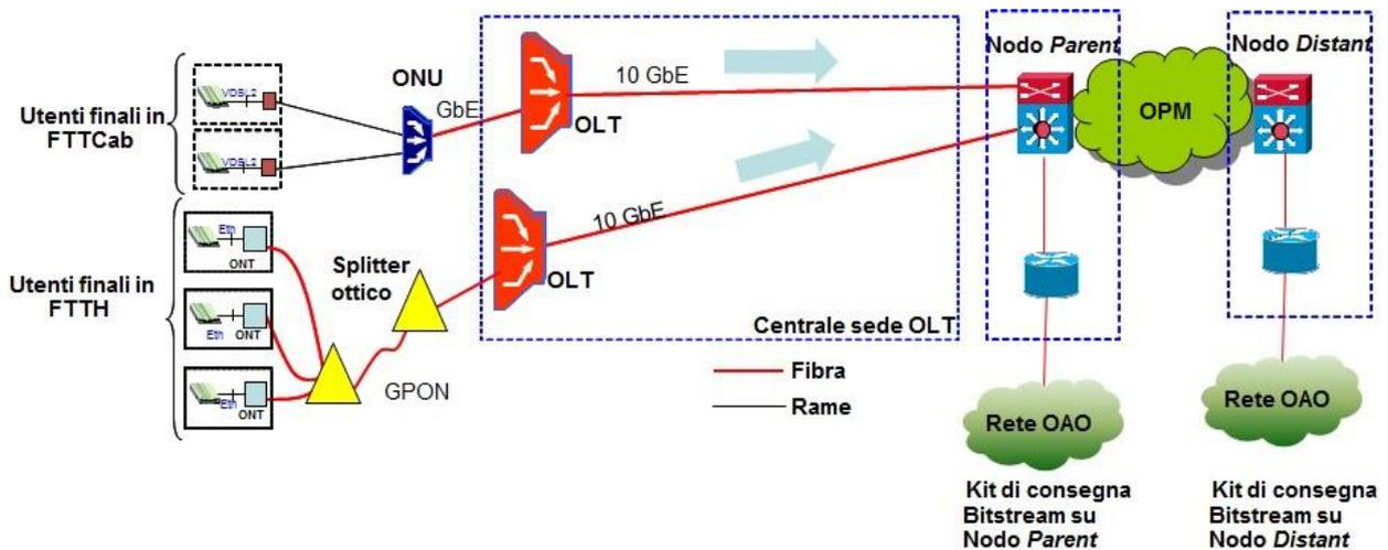
Figura 2: Architettura della rete di accesso per i servizi bitstream su rete NGA
