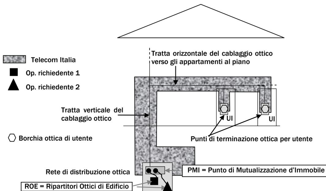
**Figura 3: Architettura per la fornitura del servizio Segmento di Terminazione in Fibra Ottica**
