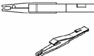
**Figura 44: Dettaglio del contatto IDC**
