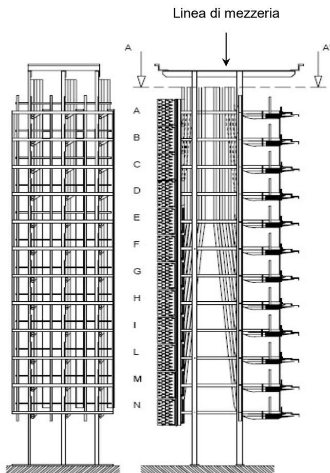
**Figura 36: Discesa cavi su Ripartitore elettrico RP3C/12L vista frontale e laterale**
