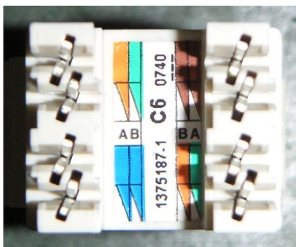
**Figura 61: Esempio di connettore femmina lato striscia**
