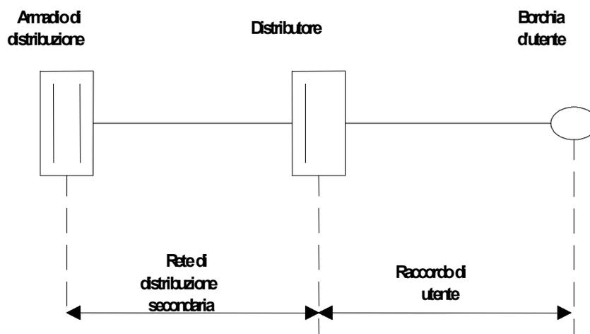
**Figura 13: Sottorete di distribuzione in rame**
