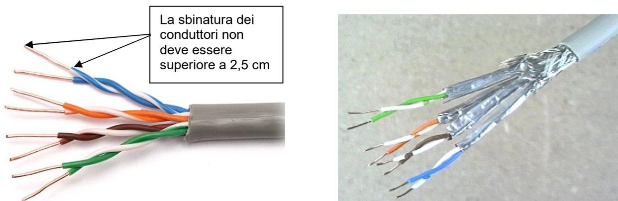
**Figura 56: Esempio di sguainatura del cavo UTP/STP**
