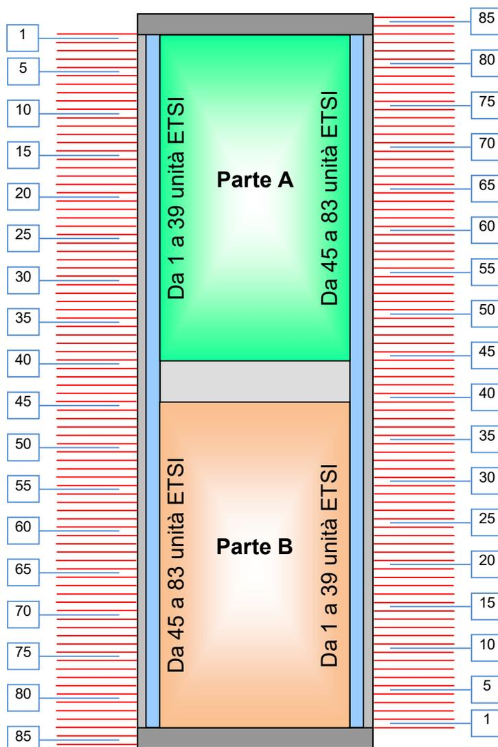
Figura 74: Parte A e Parte B nel telaio N3 da 600 x 300 x 2.200 mm
