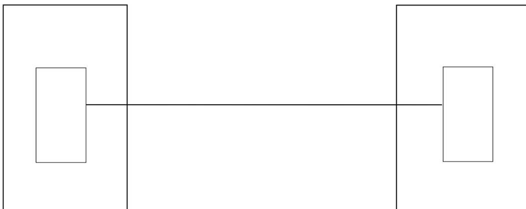
**Figura 3: Raccordi per collegamento tra due sale Operatori senza ripartitori/TTF di confine**
