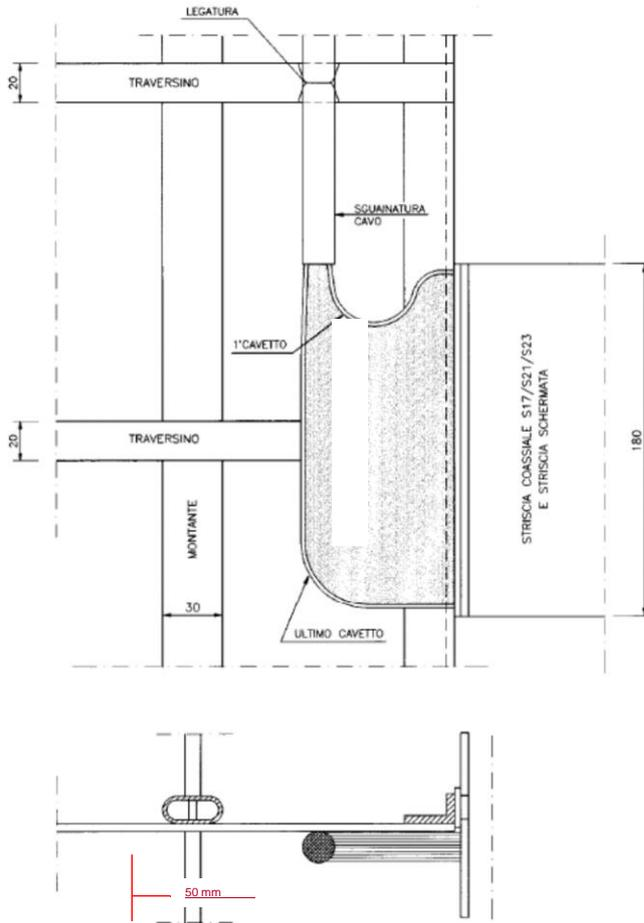
Figura ~~66~~68 Sagomatura dei cavi AF senza schermo elettromagnetico su Ripartitore (~~lato~~
