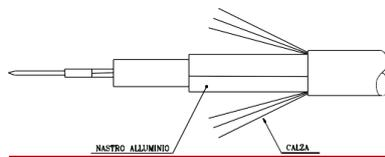
Figura 88 - Separazione della calza dal nastro di alluminio
