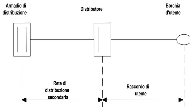
**Figura 13: Sottorete di distribuzione in rame**
