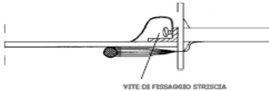
Figura ~~38:39~~ Sagomatura cavi BF con schermo elettromagnetico o elettrostatico sui ripartitori/permutatori (~~lato verticale~~ LATO VERTICALE)
