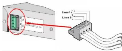
Figura 78 - Terminazione cavo unipolare su connettore di tipo plastico a morsettiere
