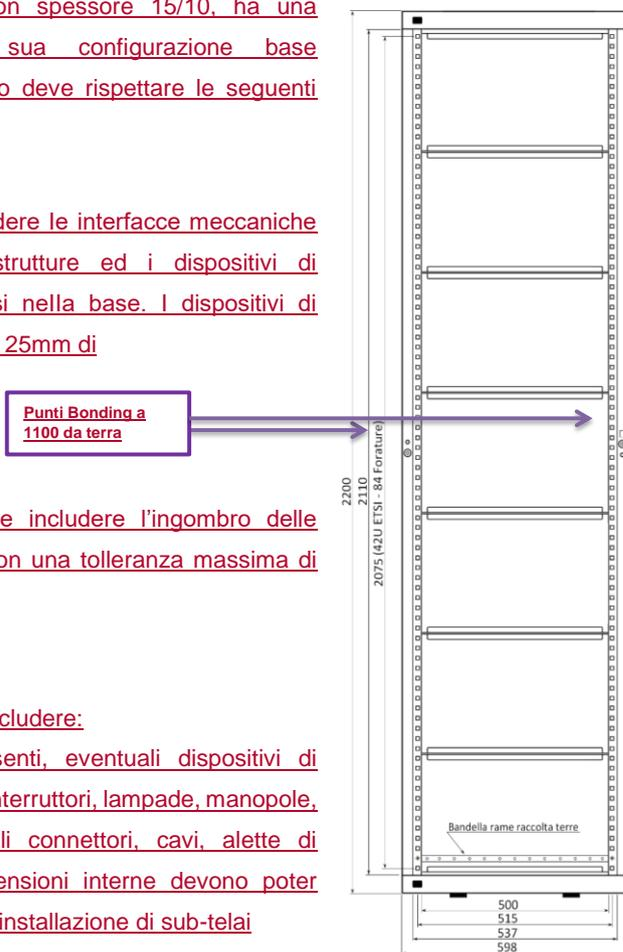
Figura 19 Struttura Base Telaio
