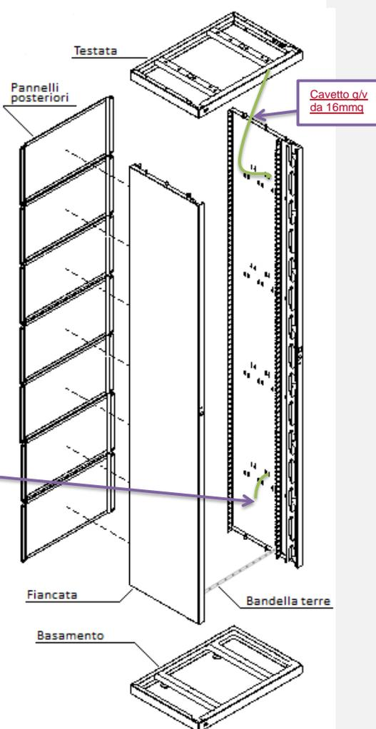
Figura :—20 Componenti principali Telaio
