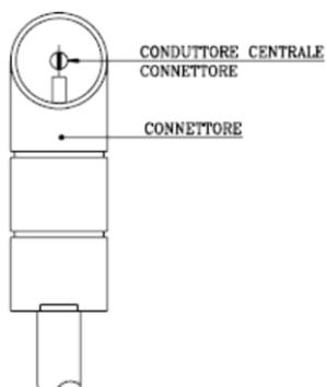
Figura 96 - Inserimento del cavo nel connettore e fissaggio tramite saldatura
