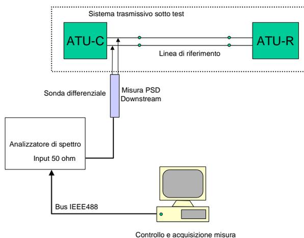
La misura della densità spettrale di potenza trasmessa dall'ATU-C nella direzione Downstream ha lo scopo di verificare che il trasmettitore rispetti la maschera riportata nella Raccomandazione ITU-T G.992.1 par. B.1.3.
