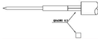
Figura 87 - Crimpatura del conduttore centrale
