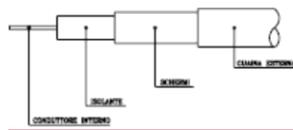
2. Inserire il conduttore interno del cavo all'interno dello spinotto centrale del connettore fino a battuta
