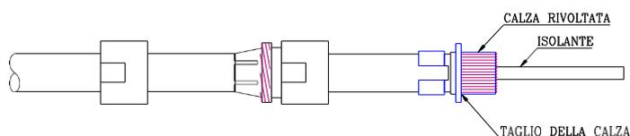
Figura 94 - Preparazione del cavo
