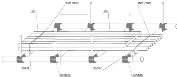
Figura ~~30:27~~ Esempio di legatura a "Fascio"
