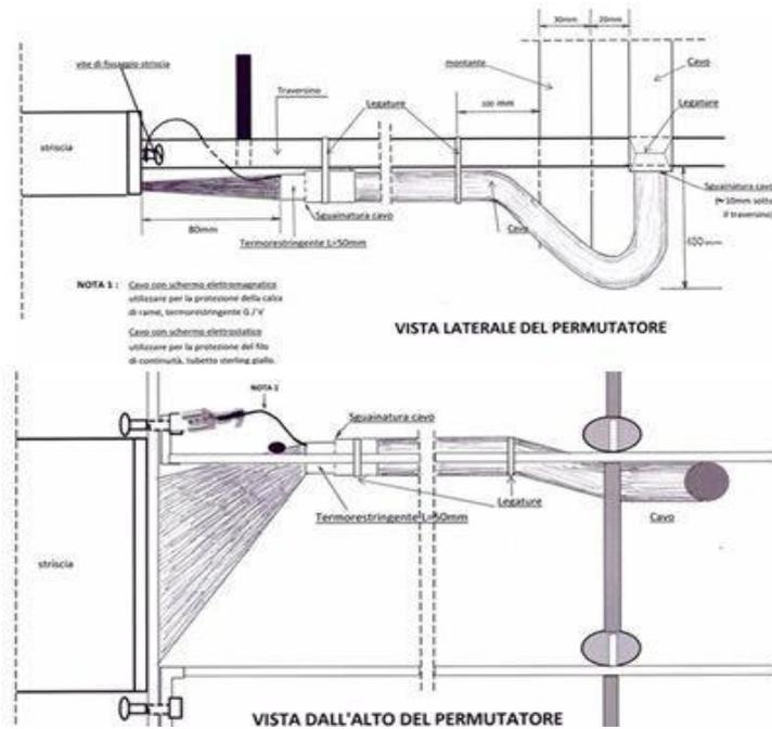
Figura 43:44 – Sagomatura dei cavi BF con schermo elettromagnetico o elettrostatico sui permutatori (~~lato orizzontale~~LATO ORIZZONTALE)
