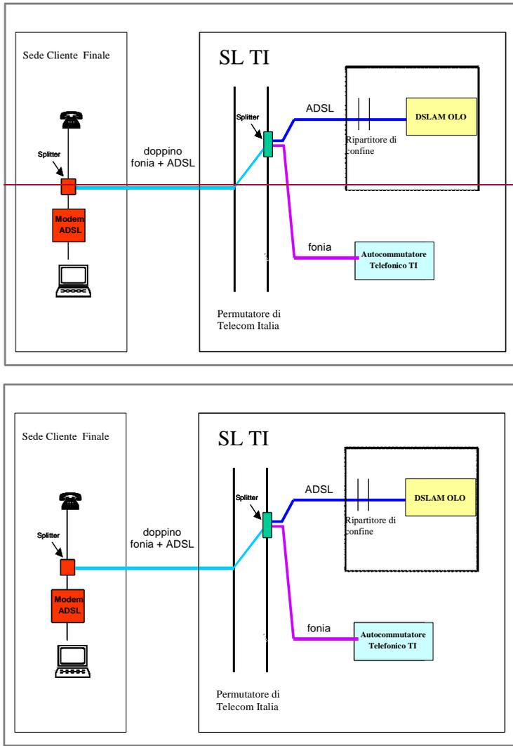
**Figura 12: Catena impiantistica in caso di *shared access* con splitter fornito da Telecom Italia**
