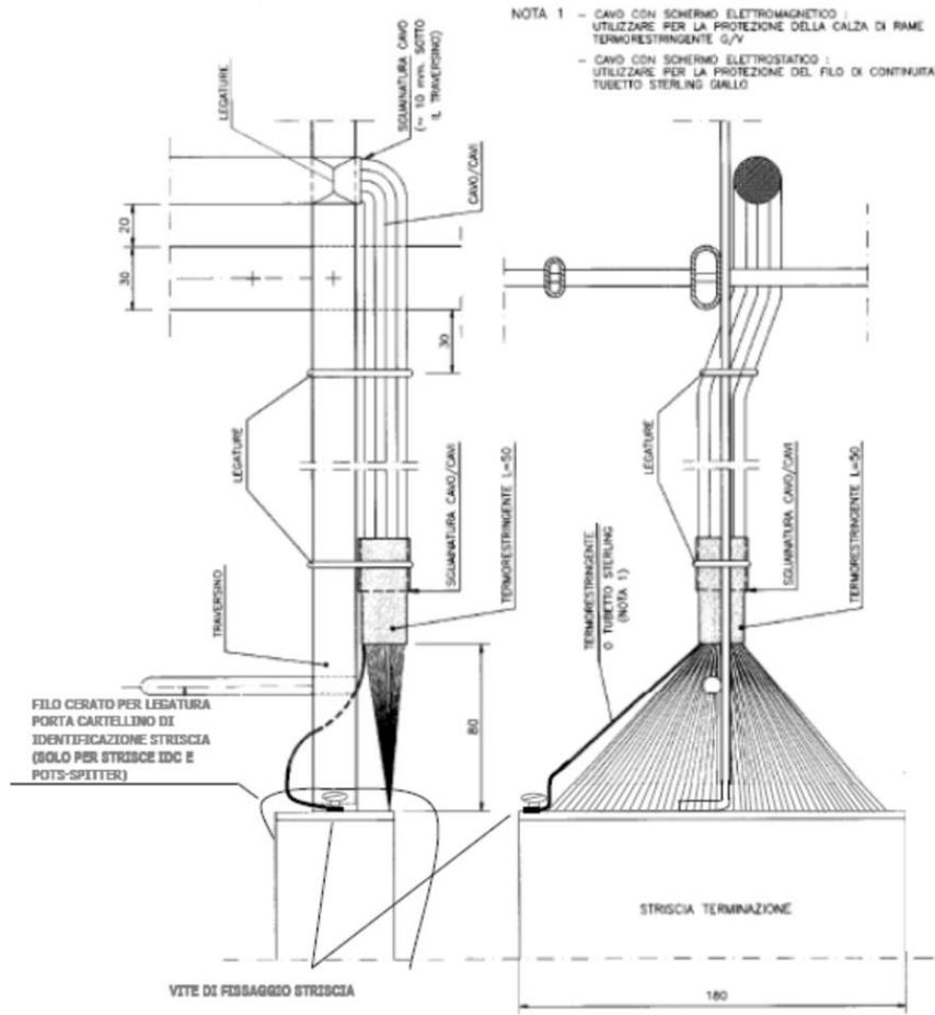
Figura ~~39~~40 - Sagomatura cavi BF con schermo elettromagnetico ~~e~~/elettrostatico ~~sui~~
