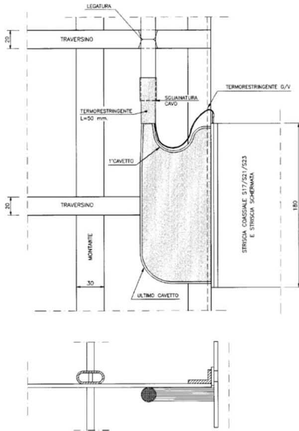
Figura ~~65-67~~ Sagomatura dei cavi AF con schermo elettromagnetico su Ripartitore (~~lato~~
