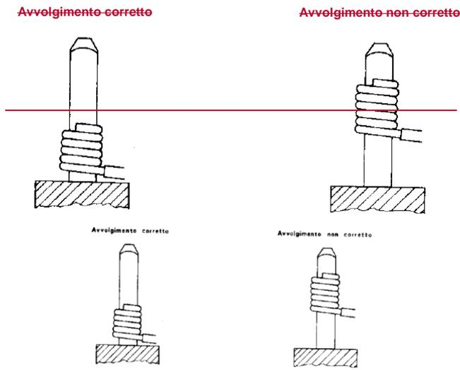
Figura 53:55 – Distanza della connessione dal supporto striscia (corretto quello di sx, non corretto quello di dx)
