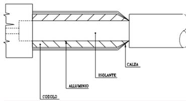
Figura 89 - Inserimento del cavo nel connettore
