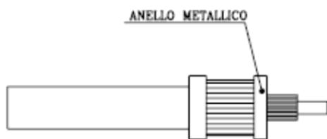
Figura 100 - Inserimento dell'anello metallico
