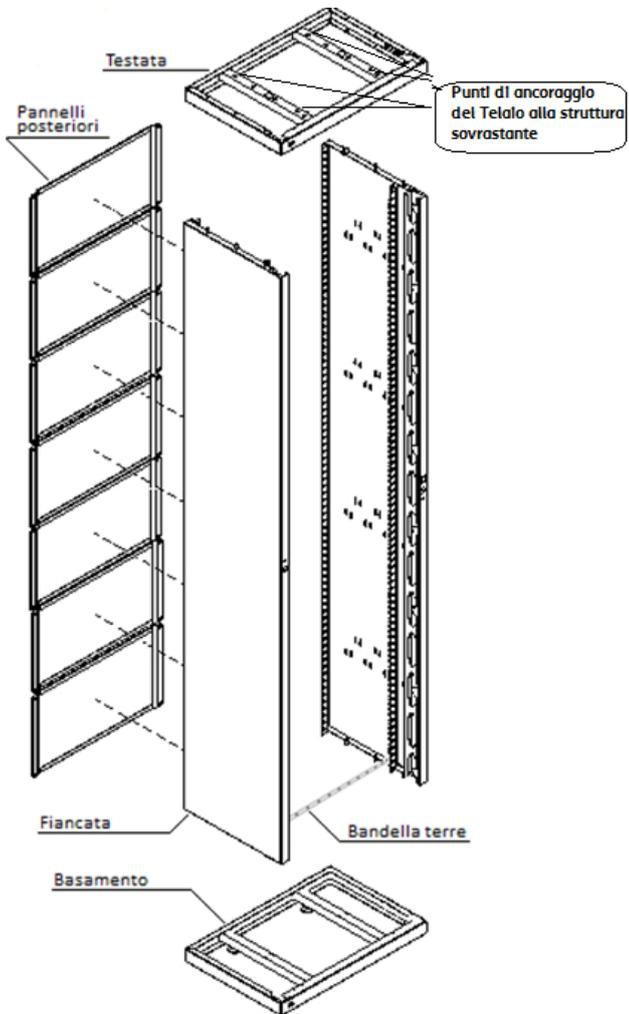
**Figura 40a: Composizione e fissaggio del telaio per strutture di nuova generazione ST2016**
