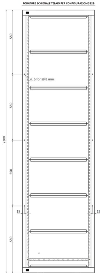
Figura 28 Punti di interfaccia
