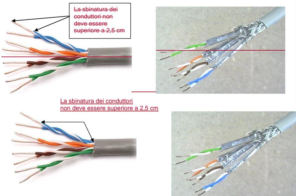
Figura ~~56~~:58 – Esempio di sguainatura del cavo UTP/STP
