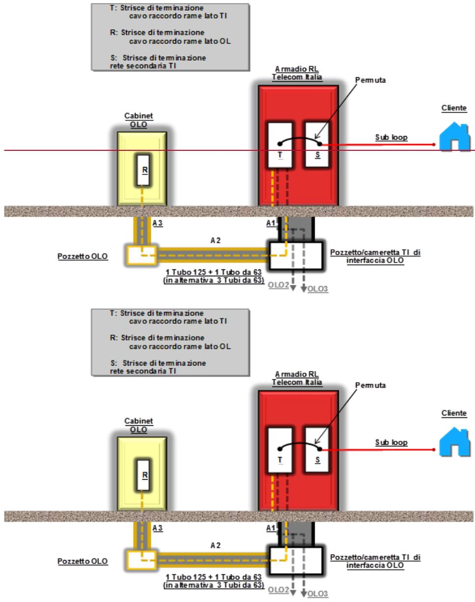
Figura 7: Colocazione per servizi di accesso disaggregato alla sottorete locale
