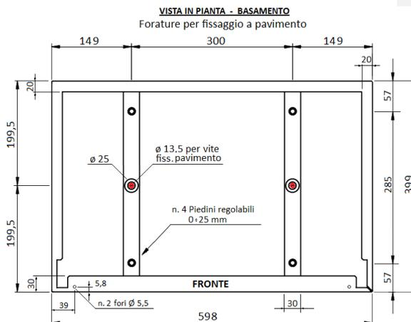
Figura 29 Piano foratura per fissaggio a terra
