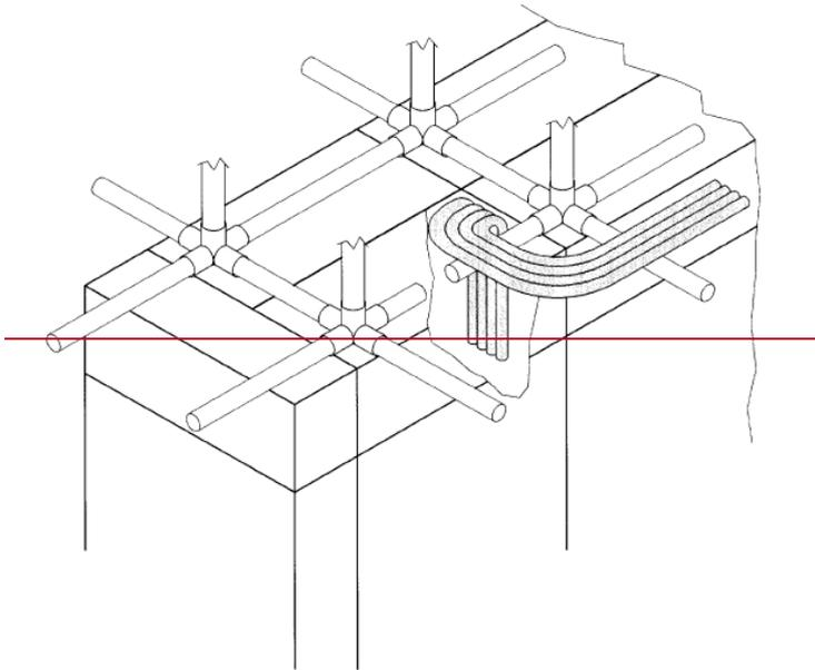
Figura ~~27~~:24 Esempio di posa cavi sulla struttura di fila e discesa verso l'apparato
