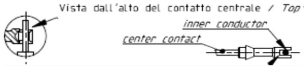
6. Crimpare mediante l'apposita pinza La crimpatura deve essere eseguita in modo tale da interessare solo il 90% della lunghezza del tubetto. La quota non interessata dalla crimpatura deve essere quella lato cavo
