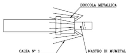
Figura 97 – Asportazione guaina e inserimento della boccola metallica
