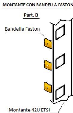
Figura 25 Particolare B bandella faston su montante dx
