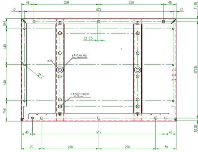
**Figura 30** piano di foratura per fissaggio del sopralzo
