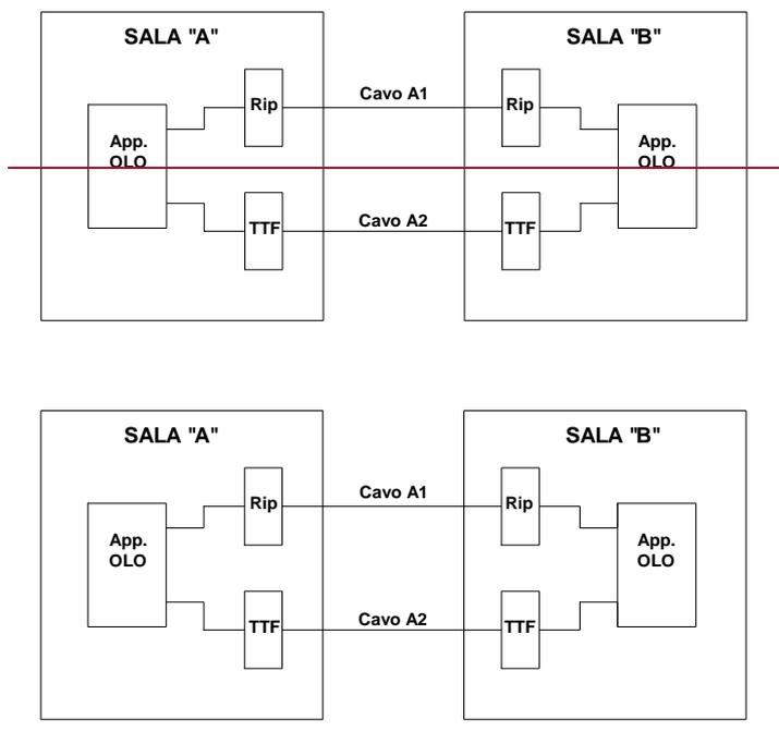
**Figura 4: Raccordi per collegamento tra due sale Operatori con Ripartitori/TTF di confine**
