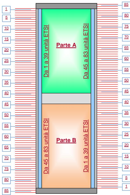
Figura 41: Parte A e Parte B nel telaio N3 da 600 x 300 x 2.200 mm
