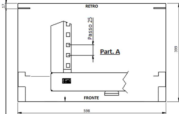
**Figura 32** Piano posizionamento montanti ETSI
