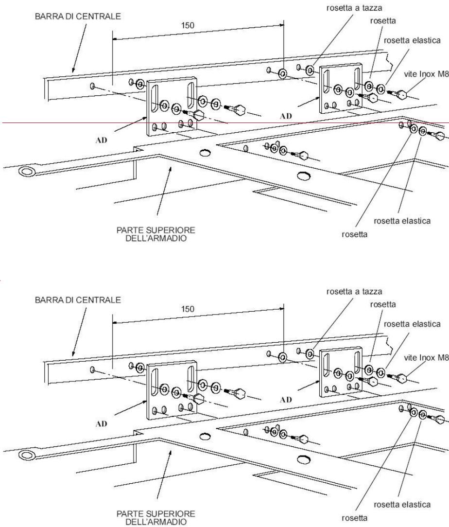
Figura 39: Fissaggio del telaio alla struttura di fila fino alla ST2009
