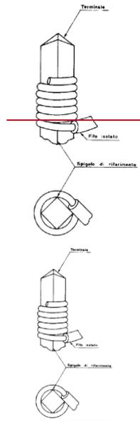
Figura ~~46~~48 – Esempio di connessione avvolta
