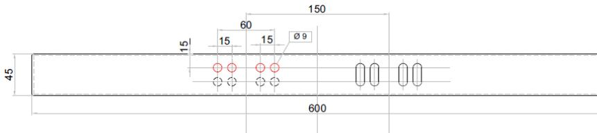
**Figura 31** Piano di foratura per fissaggio biscotti
