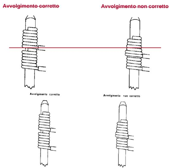
Figura 54:56 – Esempio di doppia connessione sullo stesso terminale (corretto quello di sx, non corretto quello di dx)
