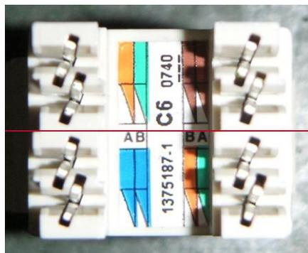
Figura ~~64:63~~ – Esempio di connettore femmina lato striscia
