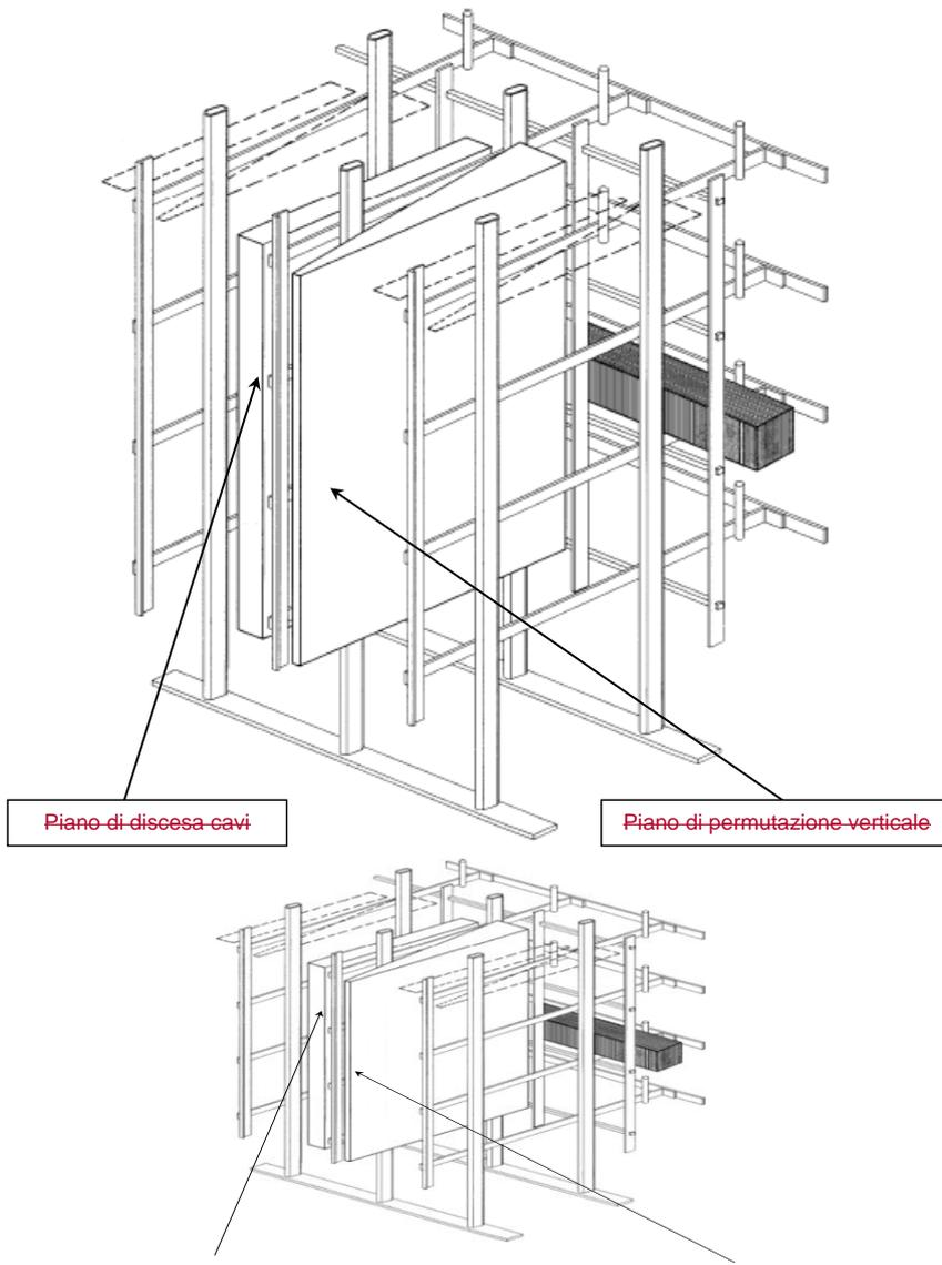
Figura 22:11 Piano di discesa cavi e Piano di ~~permutazione verticale~~Permutazione Verticale
