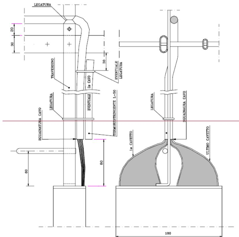
Figura 68:70 Sagomatura dei cavi AF senza schermo elettromagnetico nei Ripartitori (Lato orizzontale Lato Orizzontale)
