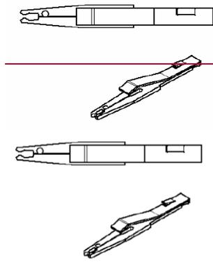
Figura ~~44:46~~46 – Dettaglio del contatto IDC
