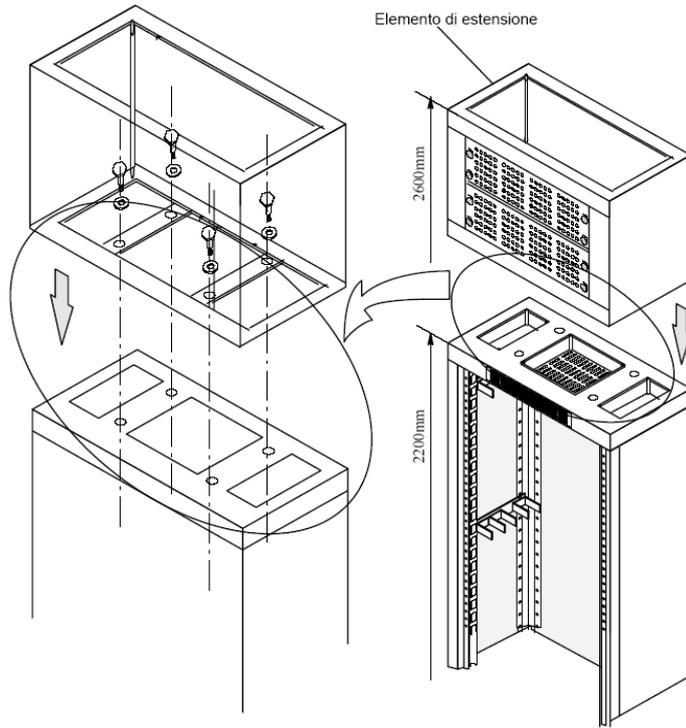
**Figura 38: Fissaggio del sopralzo per strutture rialzate da 2600mm**
