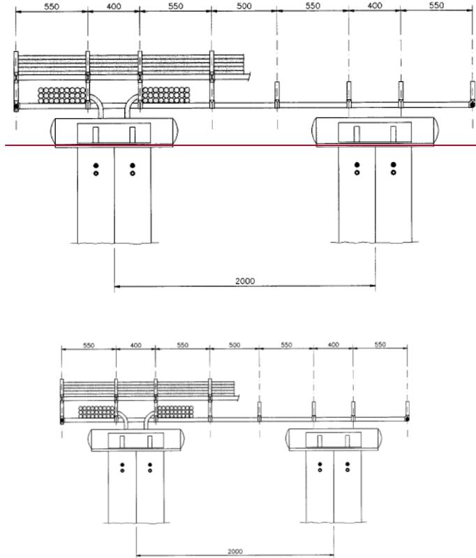
Figura ~~28-25~~ Esempio di posa cavi sulla struttura di fila e discesa verso l'apparato
