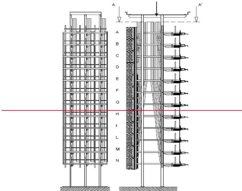
Figura 11: Esempio di discesa cavi su ripartitore RP3C
