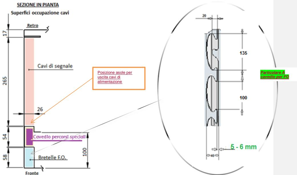
Figura 22 Superfici di occupazione cavi all'interno del Telaio
