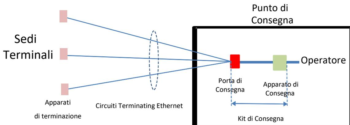
Per ogni Circuito *Terminating Ethernet su fibra ottica* è configurata una sVLAN (Service VLAN), la cui velocità può arrivare fino a 1 Gbit/s secondo la seguente granularità: da 10 Mbit/s a 100 Mbit/s a passi di 10 Mbit/s e da 100 Mbit/s a 1 Gbit/s a passi di 100 Mbit/s).
