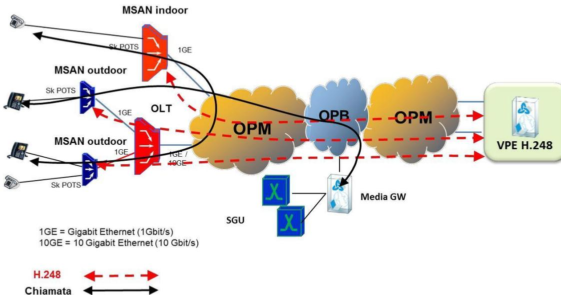
Gli MSAN-SIP e H.248 sono collegati alla rete Metro Ethernet OPM (Optical Packet Metro) direttamente (tramite fibra nuda), oppure mediante apparati di aggregazione OLT.
