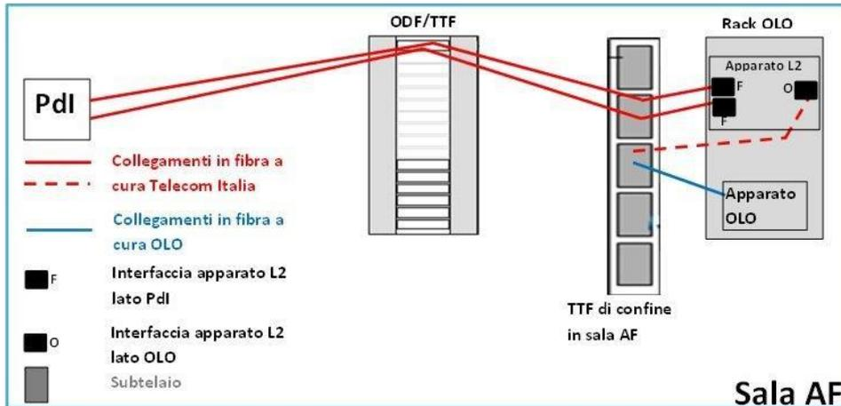
Figura 11 – Operatore in collocazione virtuale, Apparato L2 ospitato in spazi dell'Operatore
