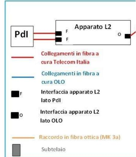
Figura 12 – Catena impiantistica – Apparato L2 ospitato in spazi Telecom Italia, Operatore in collocazione fisica¶
