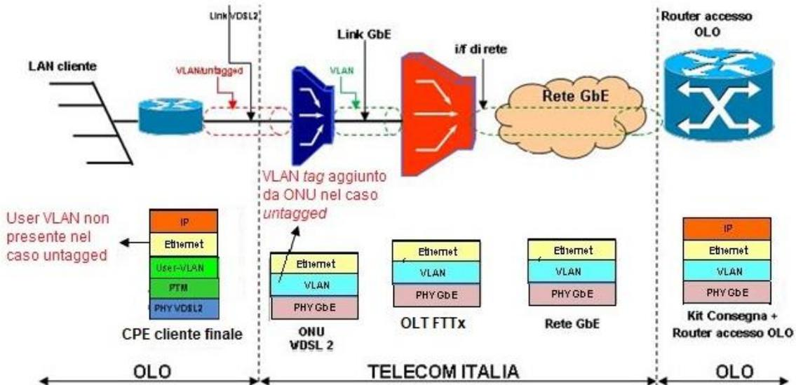
Figura 4: Protocollo IPoE su accessi FTTx su VLAN “Single tag”
