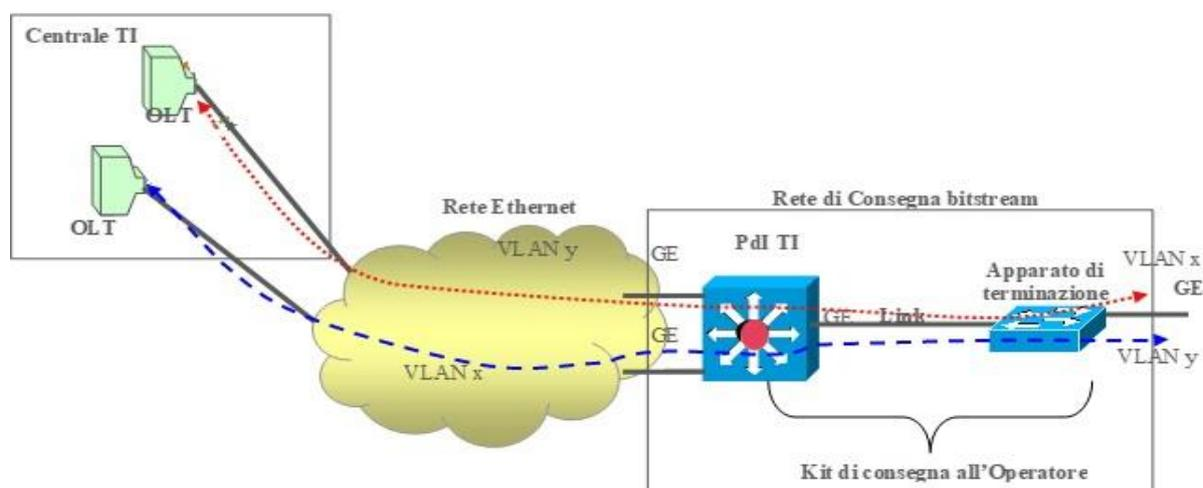
**Figura 2: Architettura del trasporto e consegna del traffico**
