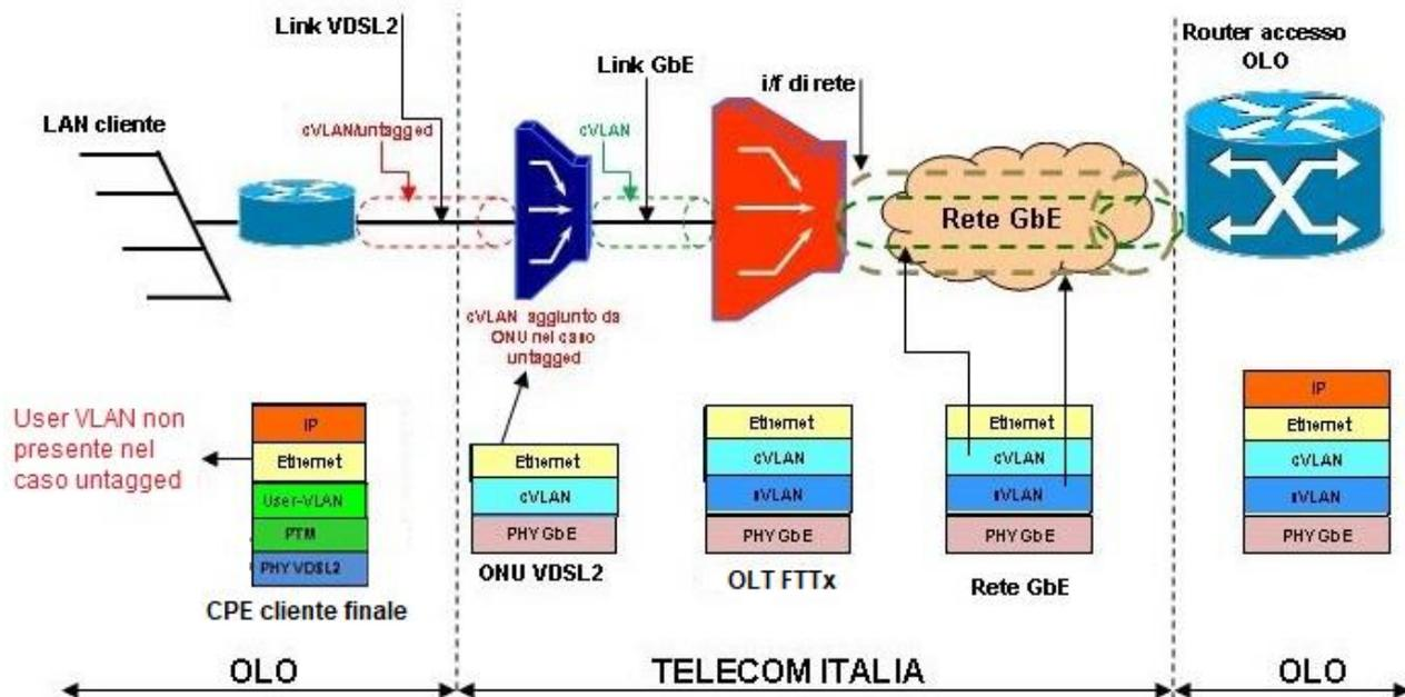
Figura 8: Protocollo IPoE su accessi FTTx su VLAN "Double tag"
