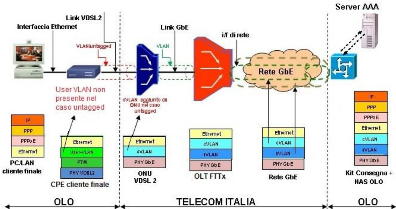
Figura 7: Protocollo PPPoE su accessi FTTx su VLAN "Double tag"
