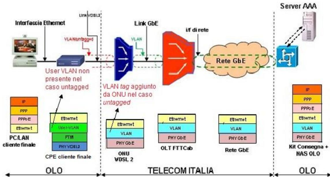
Figura 3: Protocollo PPPoE su accessi FTTx su VLAN “Single tag”
