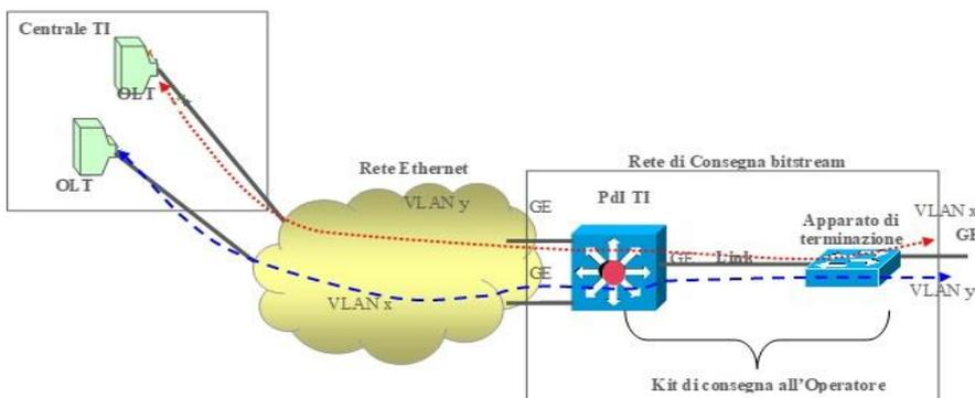
**Figura 3: Architettura del trasporto e consegna del traffico**
