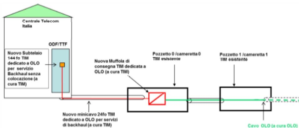
**Figura 2 : Accesso alla Cameretta Zero tramite Pozzetto Uno**
