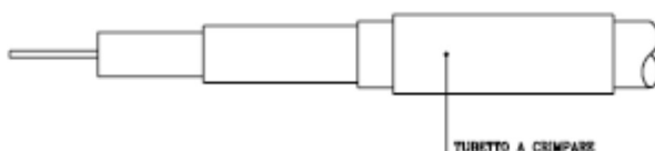
Figura 86 - Inserimento del tubetto a crimpare
