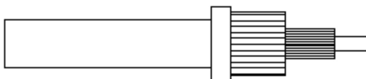
Figura 99 - Taglio a misura del conduttore centrale
