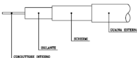
Figura 85 Disarmo del cavo
