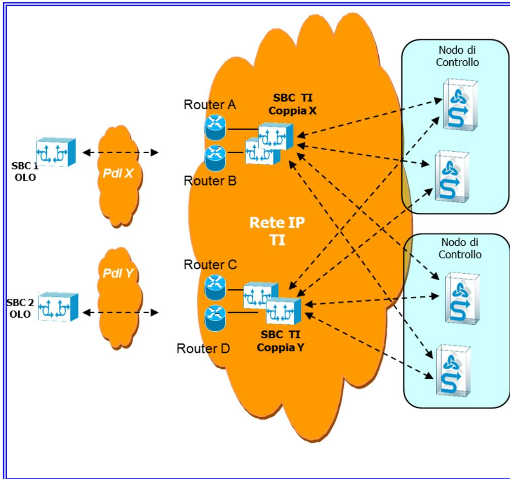
Figura 3: Modello di interconnessione di una AGW VoIP
