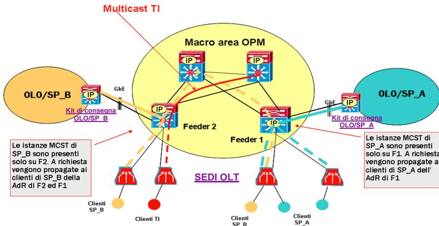
**Figura 13 – Propagazione dei canali multicast**
