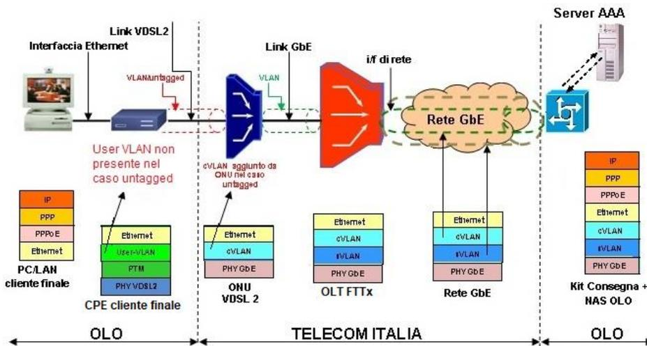
Figura 9: Protocollo PPPoE su accessi FTTx su VLAN "Double tag"
