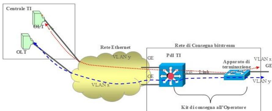
**Figura 4: Architettura del trasporto e consegna del traffico**
