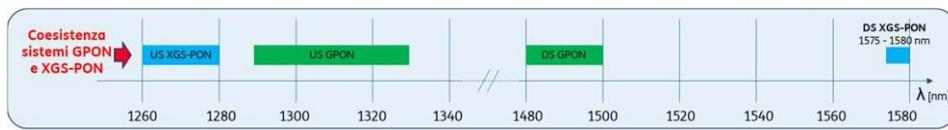
**Figura 2 - Bande spettrali GPON e XGS-PON**
