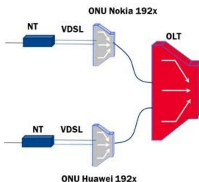
**Figura 5: Architettura di accesso per VULA VDSL bonding**
