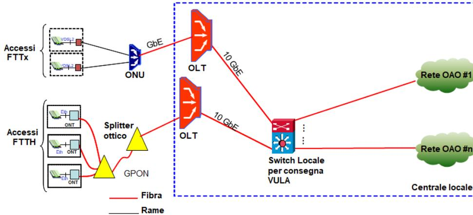
Figura 1: Architettura della rete per il servizio VULA
