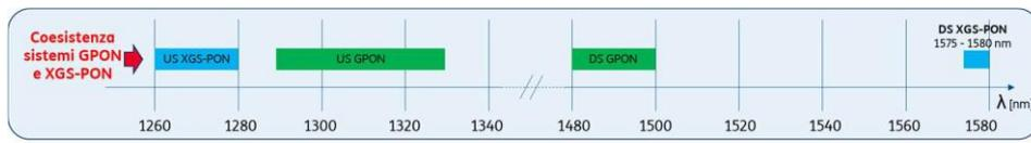
**Figura 4 - Bande spettrali GPON e XGS-PON**
