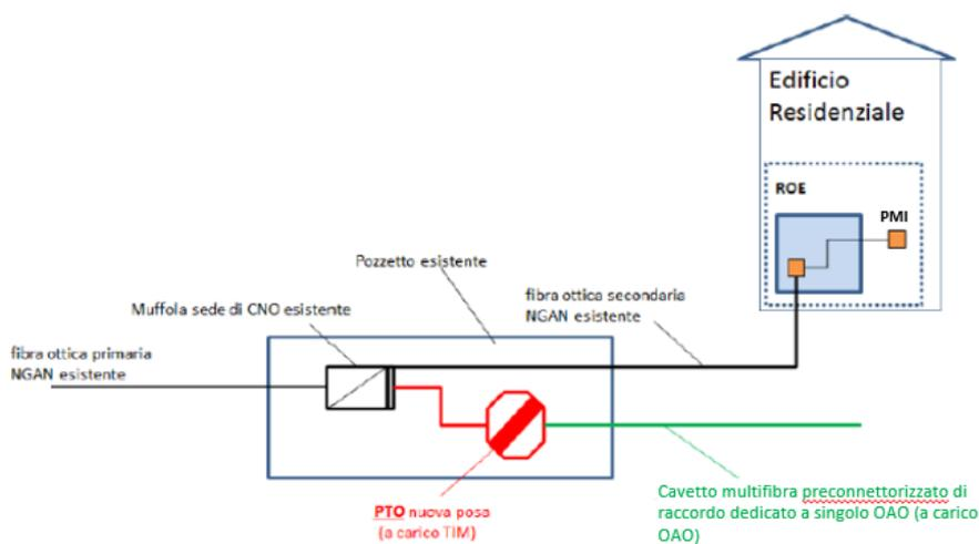
**Figura 8: Esempio di Rete Secondaria in architettura CNO**
