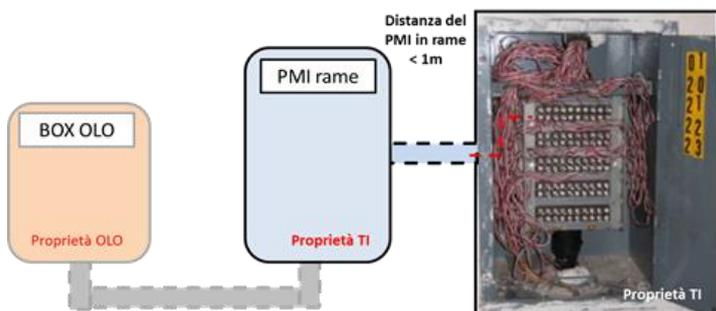
**Figura 10: Schema operativo di massima per l'infrastruttura del Segmento di Terminazione in Rame all'interno dell'edificio**
