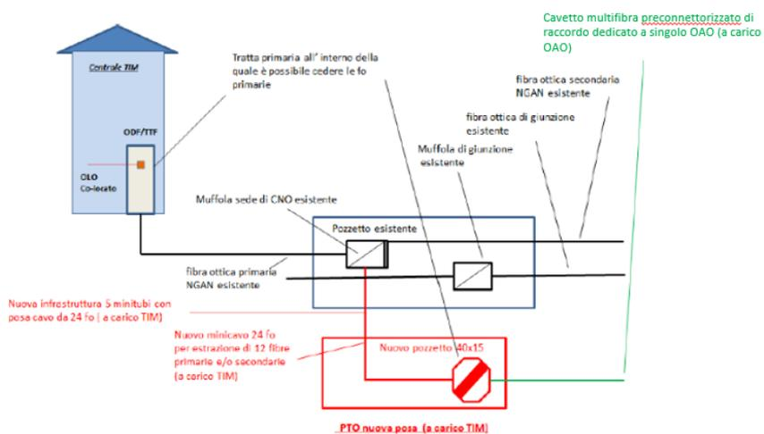
**Figura 6: Esempio di PTO con posa minipozzetto in architettura CNO**
