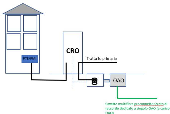
**Figura 9: Esempio di Rete Secondaria in architettura CRO**
