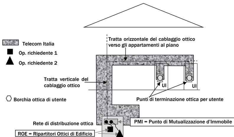
**Figura 4: Architettura per la fornitura del servizio Segmento di Terminazione in Fibra Ottica**
