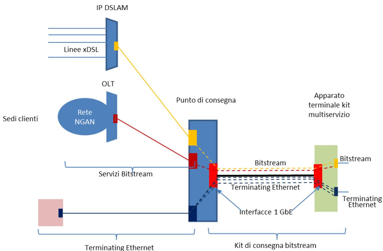
Figura 4 Raccolta circuito *Terminating Ethernet* su Kit Multiservizio
