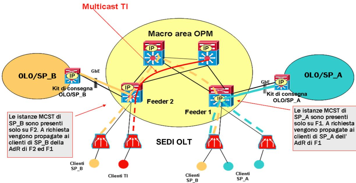
**Figura 13 – Propagazione dei canali multicast**
