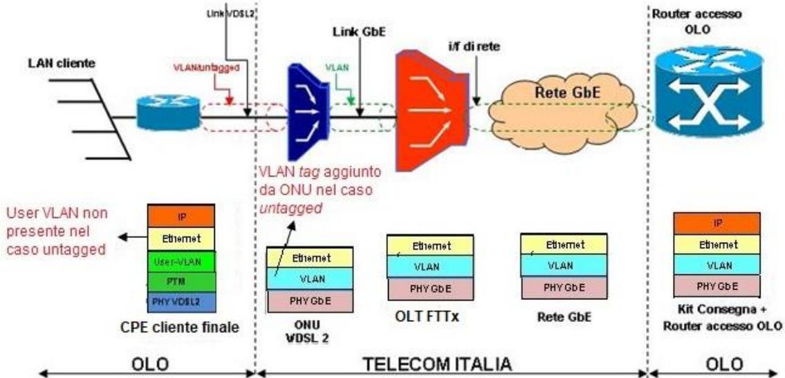
**Figura 6: Protocollo IPoE su accessi FTTx su VLAN “Single tag”**
