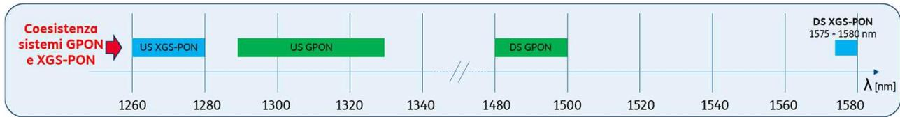
**Figura 2 - Bande spettrali GPON e XGS-PON**
