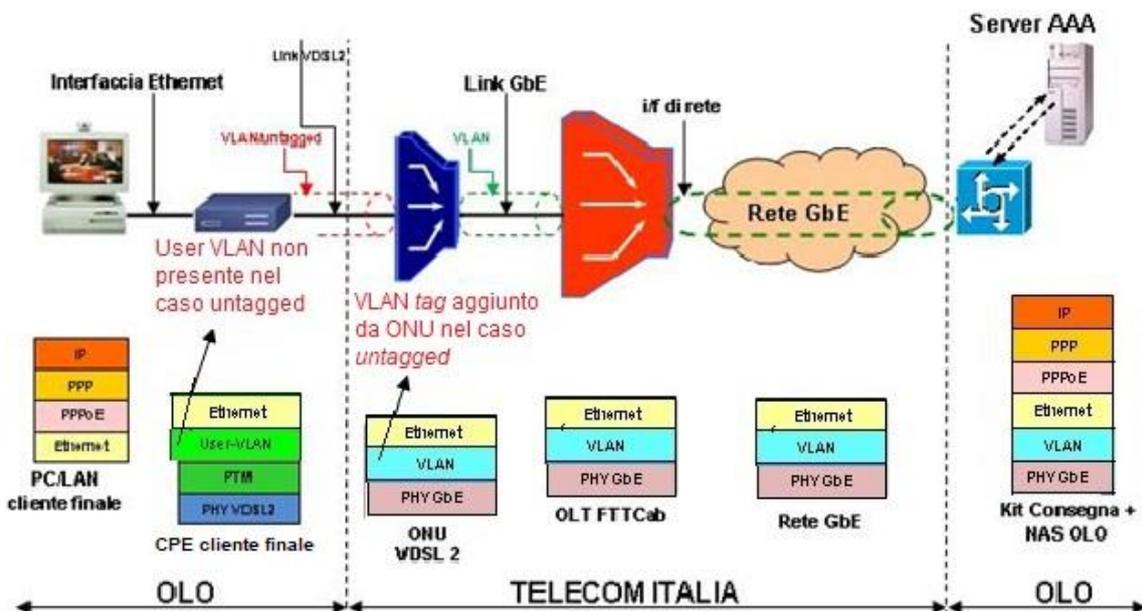
Figura 5: Protocollo PPPoE su accessi FTTx su VLAN “*Single tag*”
