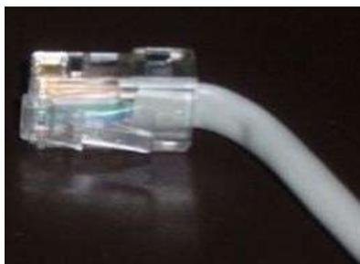
Figura 61 – Connettore maschio RJ45
