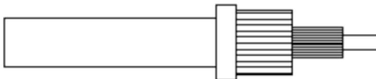
Figura 99 - Taglio a misura del conduttore centrale
