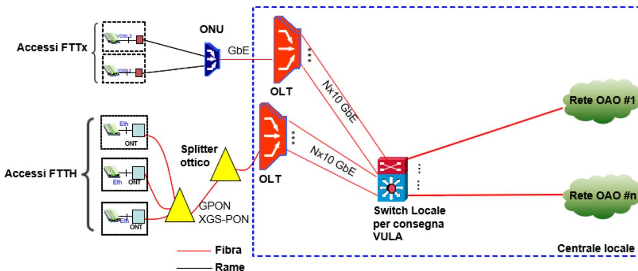
**Figura 1: Architettura della rete per il servizio VULA**
