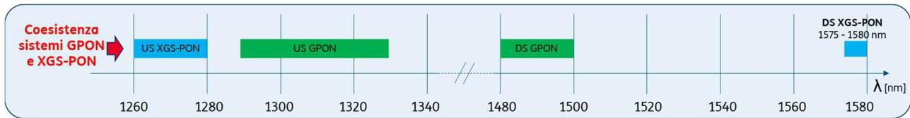
**Figura 4 – Bande spettrali GPON e XGS-PON**
