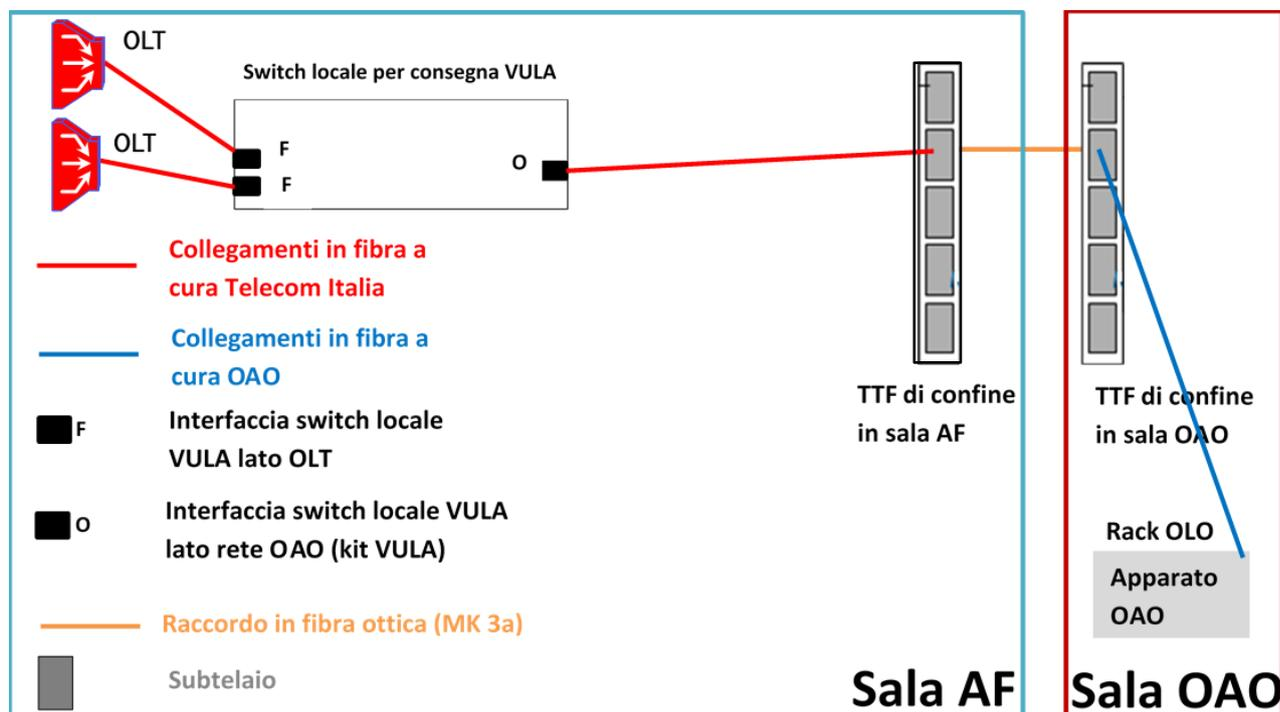
**Figura 2: Kit VULA, PoP dell'Operatore presso il nodo Telecom Italia/FiberCop in spazi dedicati all'Operatore (colocazione fisica)**
