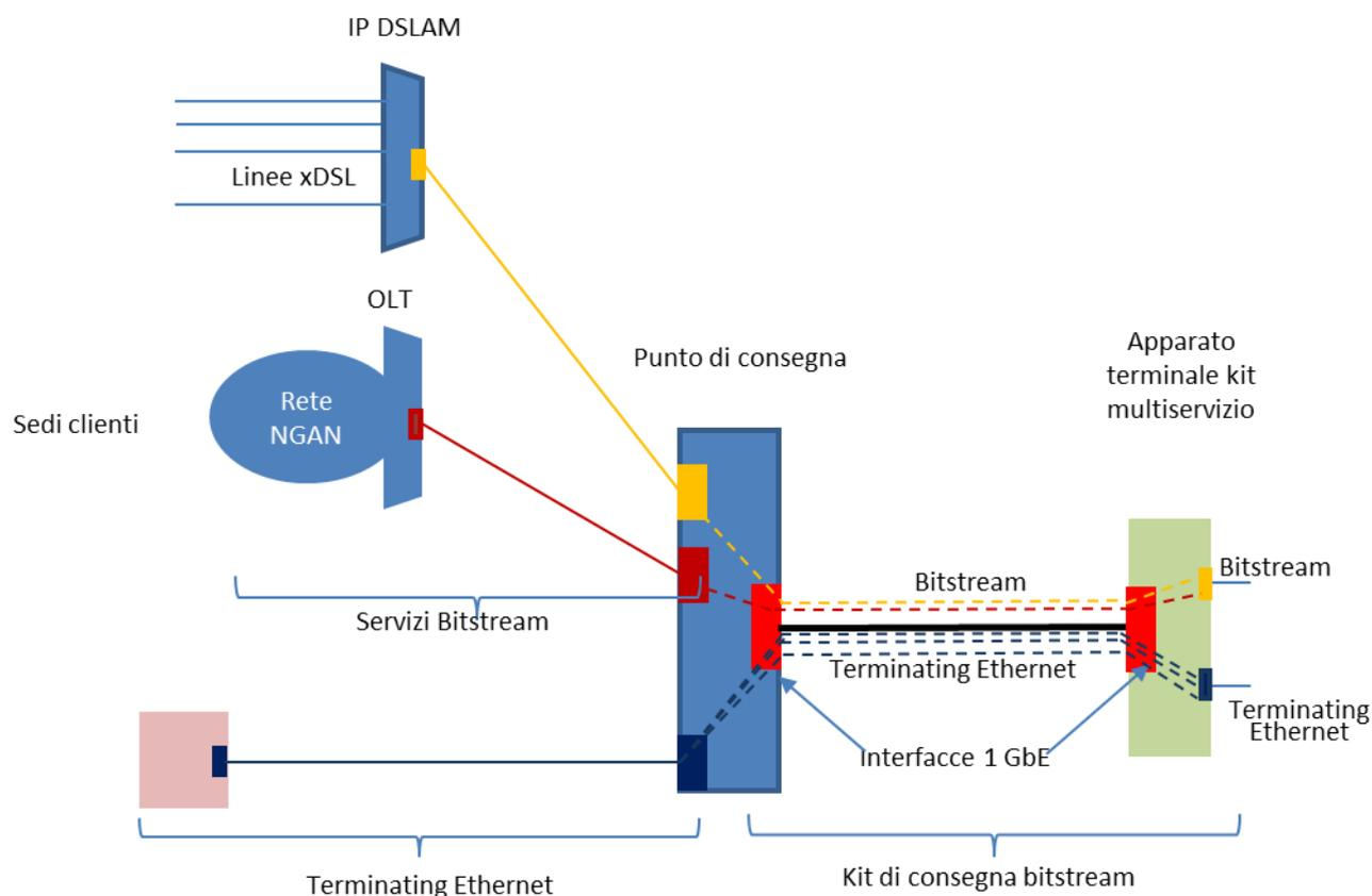
**Figura 4: Raccolta circuito Terminating Ethernet su Kit Multiservizio**
