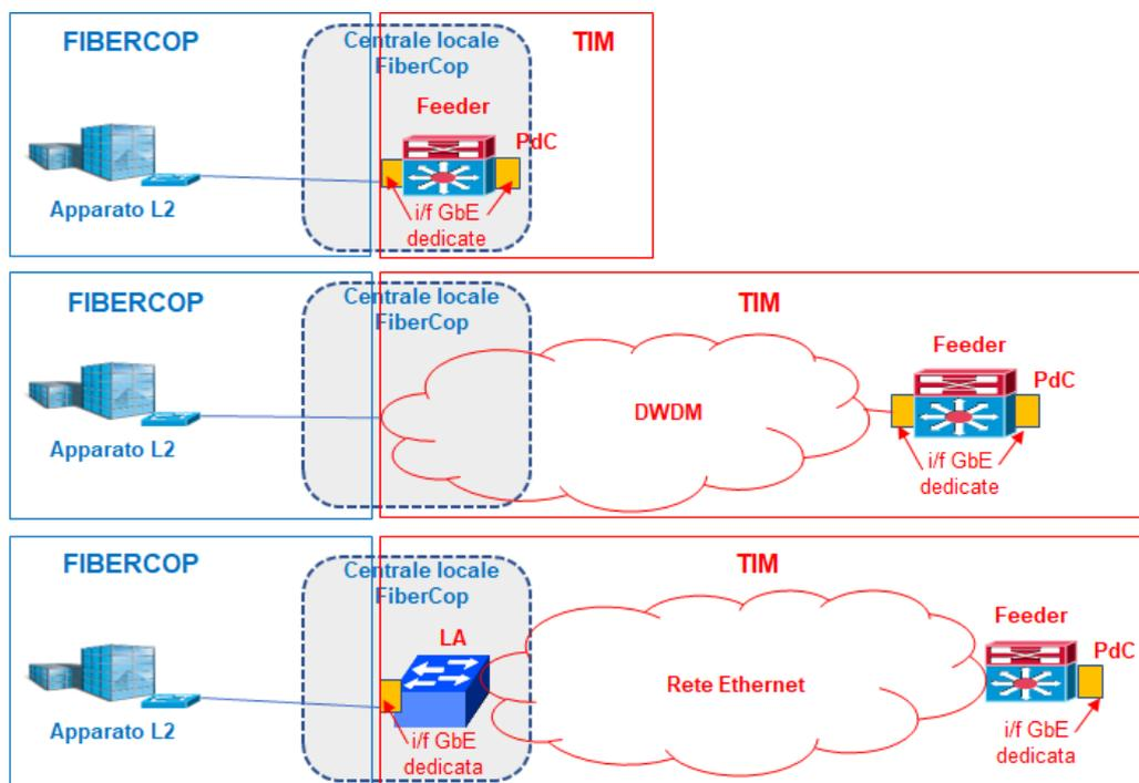
Qualora la centrale locale sia rilegata al PdC Ethernet mediante l'utilizzo di una coppia di fibre ottiche, anche quest'ultima ricade nel perimetro di FiberCop;
