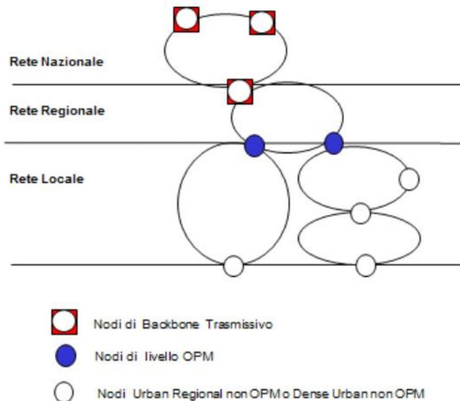
**Figura 1: Architettura della rete trasmissiva di FiberCop**
