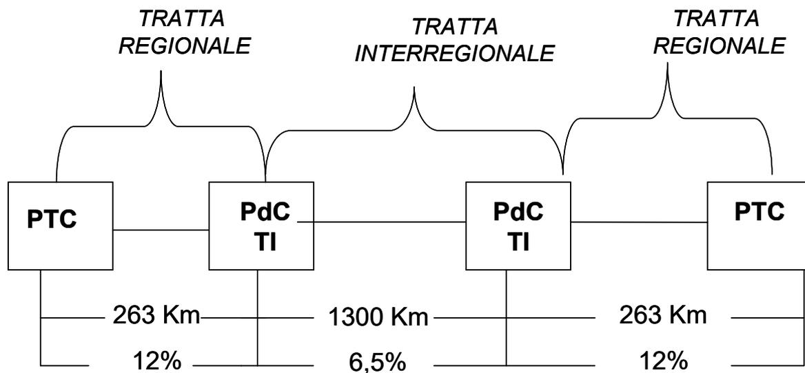
*Figura 4 – Modello di circuito di riferimento.*
