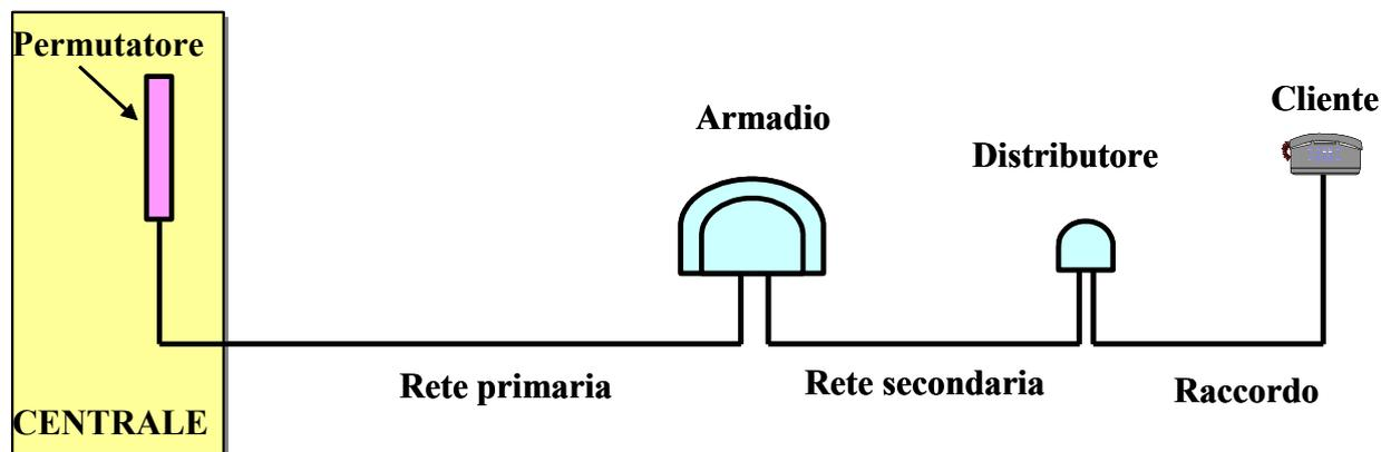
Figura 1 – Struttura della rete in rame di FiberCop.
