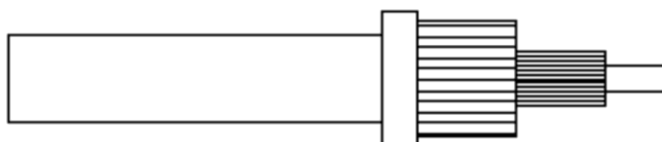
Figura 99 - Taglio a misura del conduttore centrale
