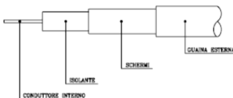
Figura 85 Disarmo del cavo
