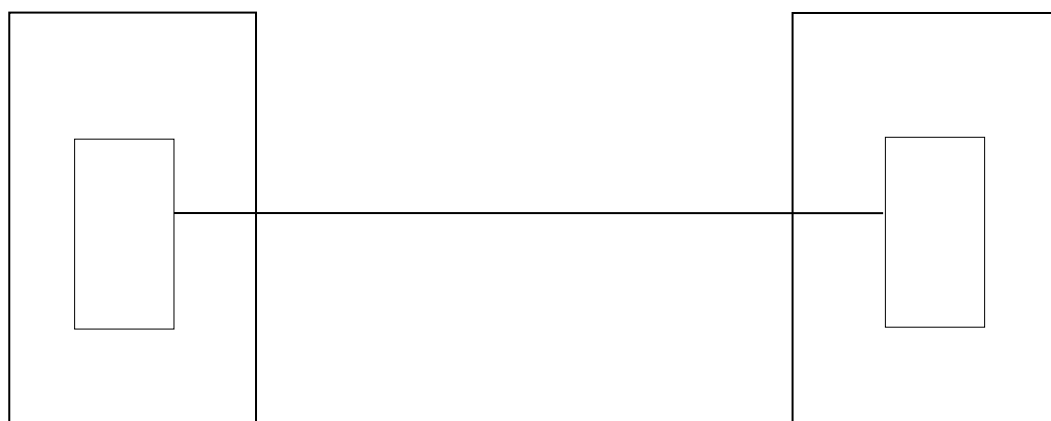
Figura 3: Raccordi per collegamento tra due sale OLO senza ripartitori/TTF di confine
