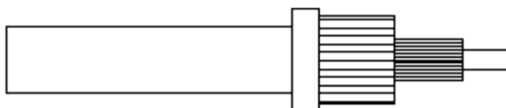
Figura 99 - Taglio a misura del conduttore centrale
