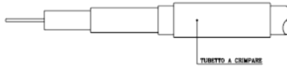
Figura 86A - Inserimento del tubetto a crimpare
